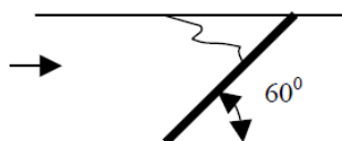
Obrázek 5 Šikmé umístění norné stěny Zdroj: Bojový řád jednotek požární ochrany-taktické postupy zásahu
