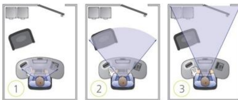
Obr. č. 19 - Zorné pole u jednotlivých druhů degresivních čoček [O14]
