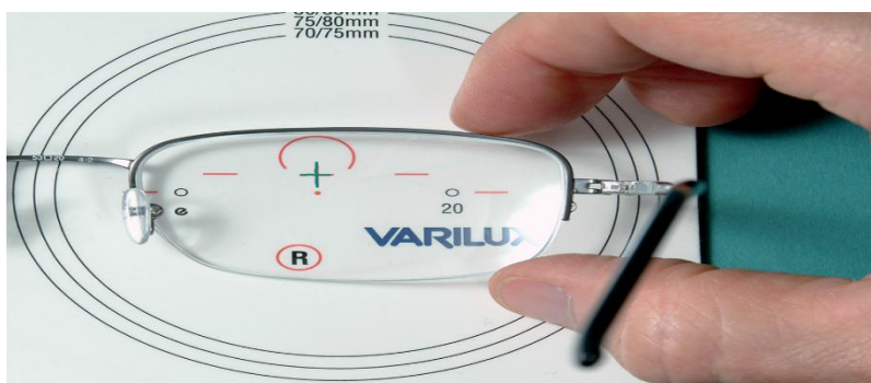
Obr. č. 17 - Centrace brýlí pomocí šablony výrobce [O11]
