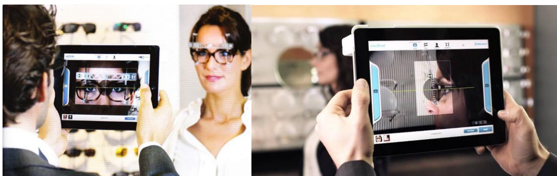
Obr. č. 24 - Ukázka měření centračním tabletem Hoya VisuReal [O17]
