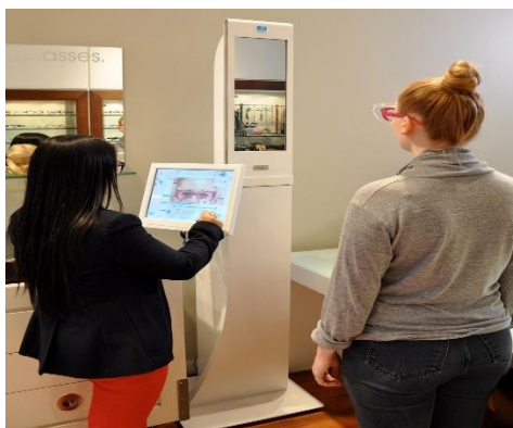
Obr. č. 20 - Ukázka probíhajícího měření na centrační věži [O15]
