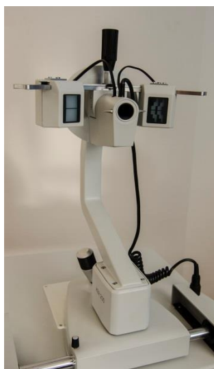
Obrázek 10: Javalův keratometr KER-200 (majetek FBMI ČVUT) [vlastní zpracování]
