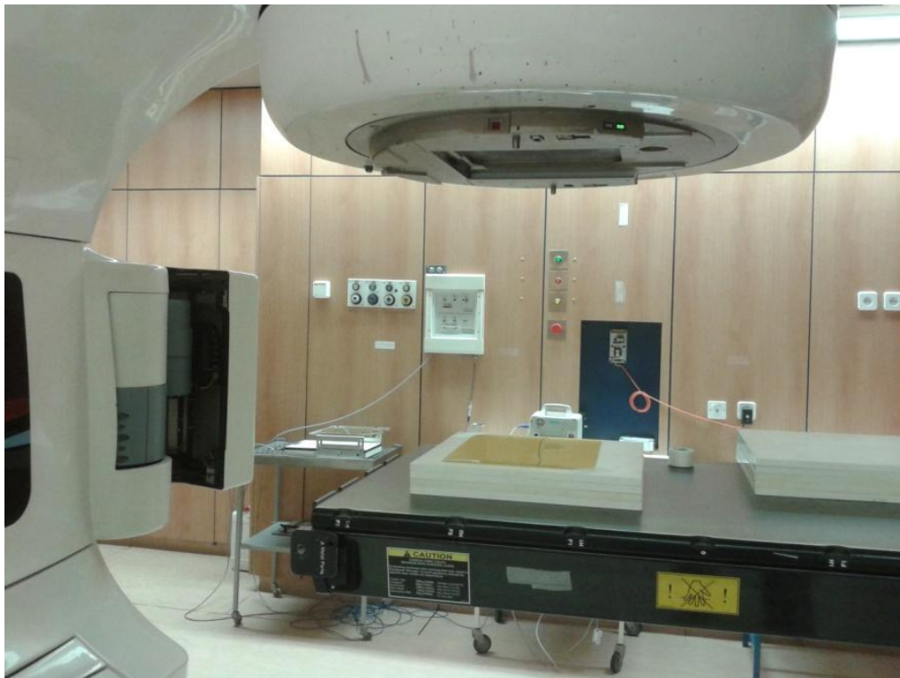
Obr. 3.4-1 – poloha filmu vůči hlavě při testování různých úhlů kolimátoru
