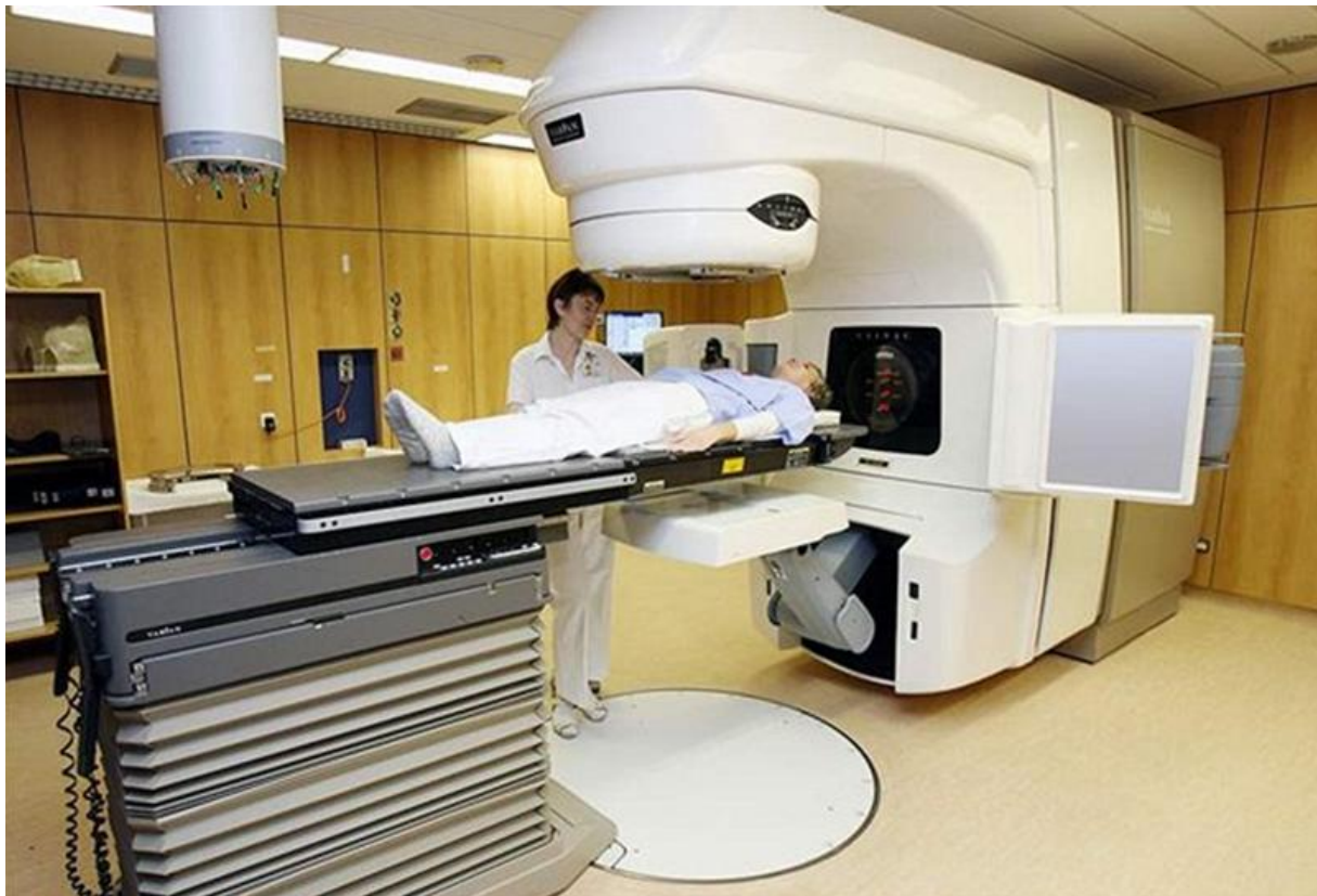
Obr. 2.1-1 – realizace lineárního urychlovače Varian Clinac 2100 C/D v ozařovně [7]
