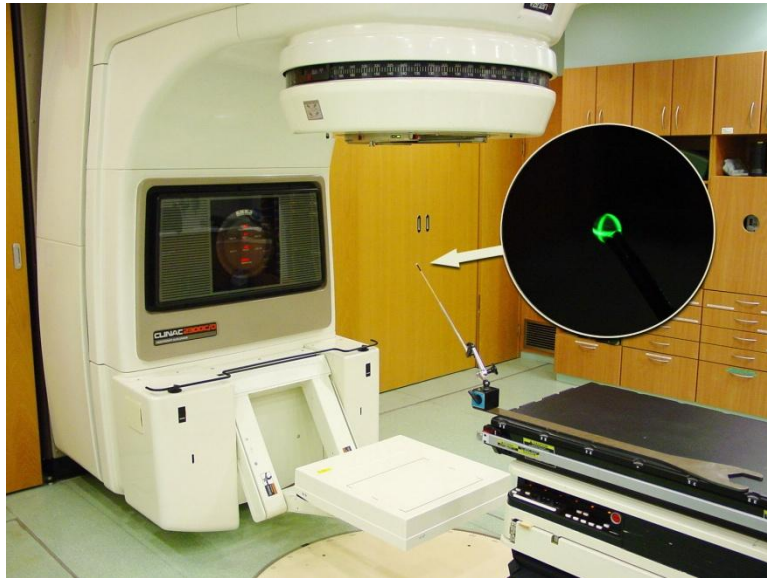
Obr. 2.5-1 – fotografie znázorňující Winston-Lutz test za využití EPID [14]
