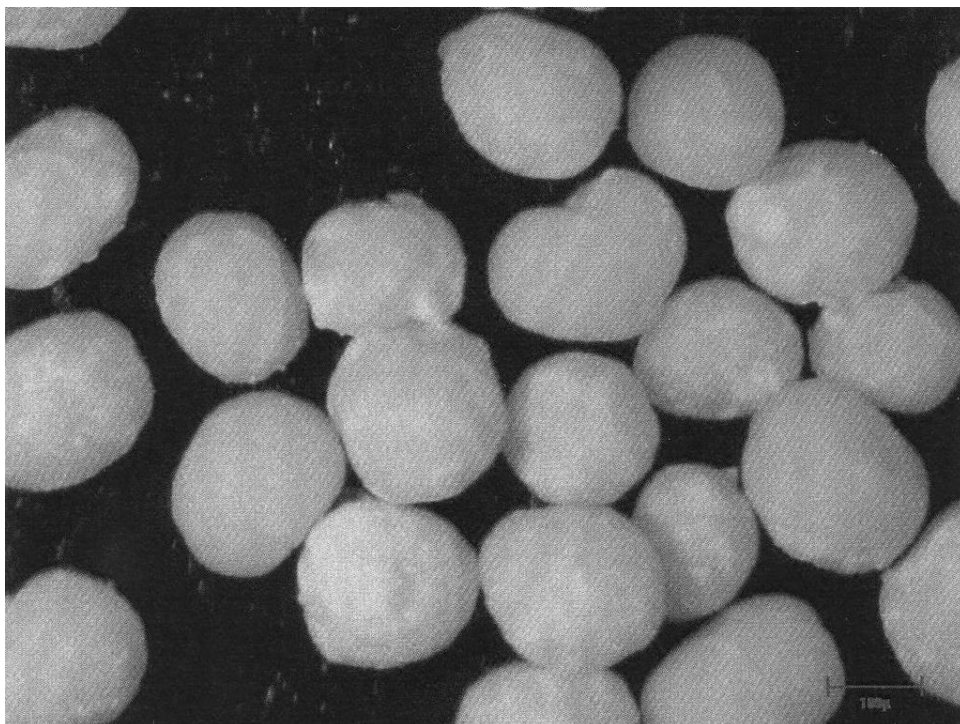
Příloha 4: Tvar pelet z mikrokrystalické celulózy Avicel 101 (ORITEST, 2012)
