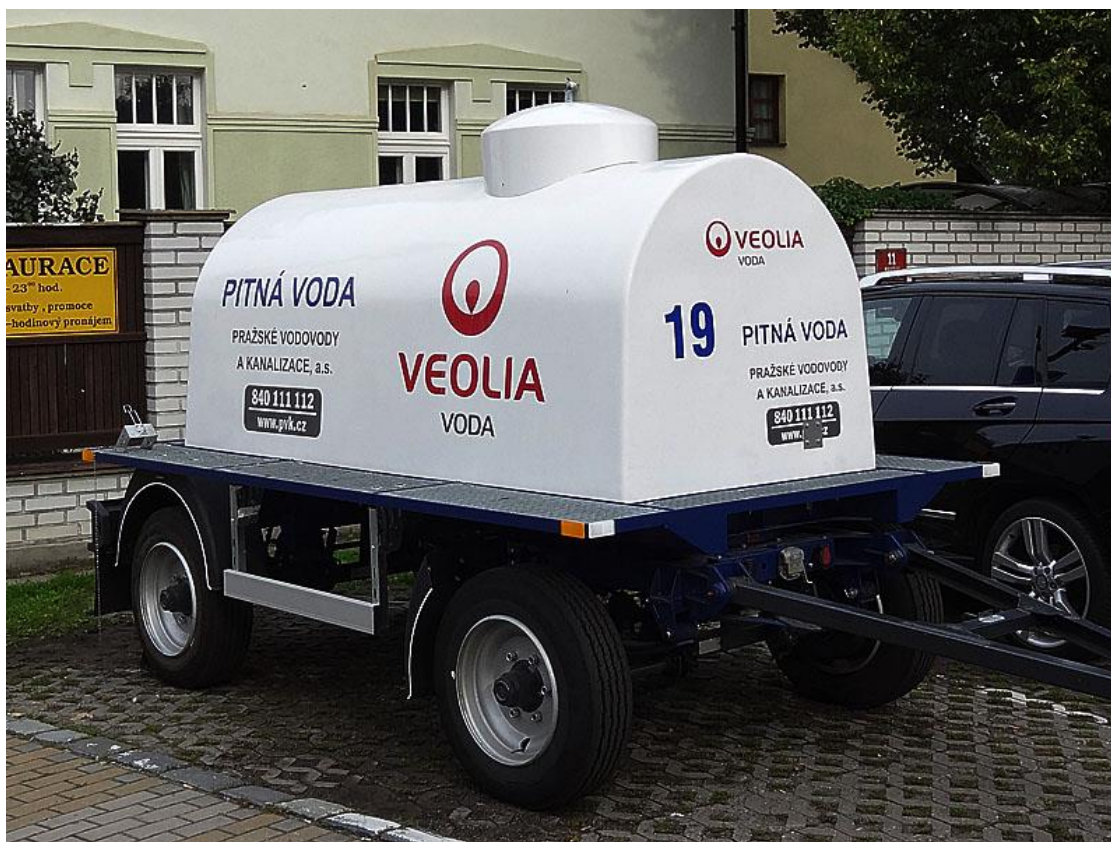
Obrázek 7 Cisterna pro náhradní zásobování pitnou vodou Foto: pražské vodovody a kanalizace
