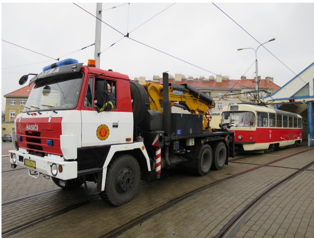
Obrázek 6 Automobilový jeřáb HZS DP Tatra 815/Berger vlekoucí tramvaj T3. Foto: Ing Michal Brunner
