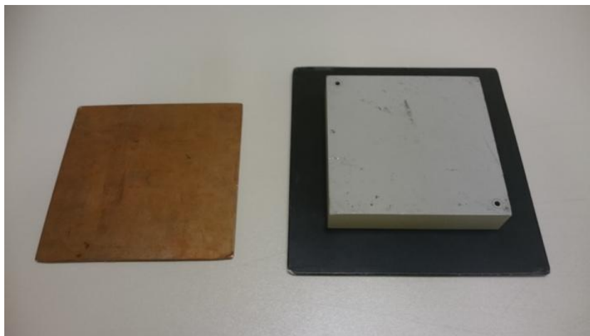
Obr. 2.1: Přídavná filtrace Cu 1mm, Al 25 mm. Fotografie: autor.
