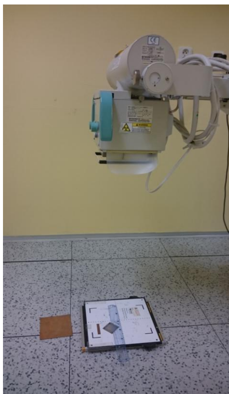
Obr. 3.2: Centrace rentgenové lampy na fantom (pojízdný přístroj Mobileart eco).
