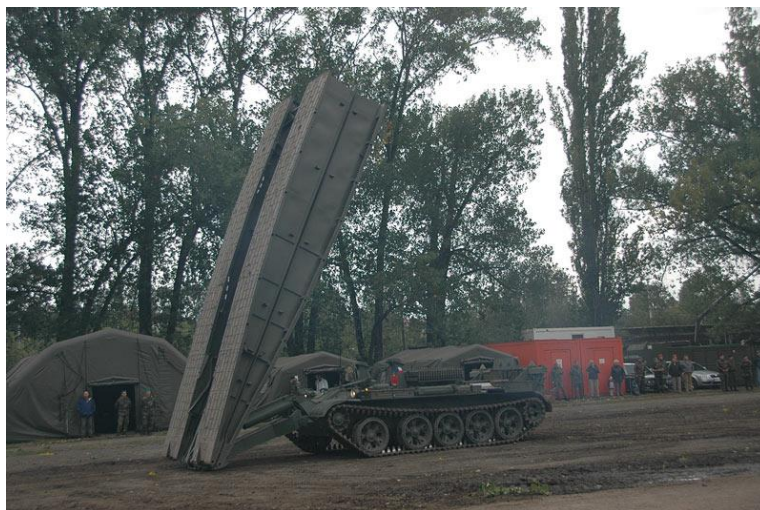
Obr. 6 - Mostní tank MT – 55 [38]
