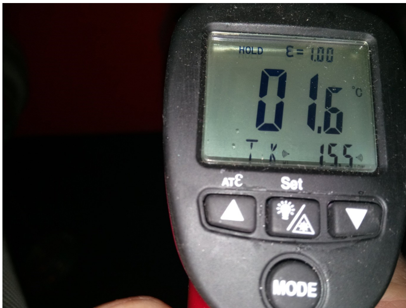
Obr. 35 – Měření teploty vody kontaktním čidlem typu K
