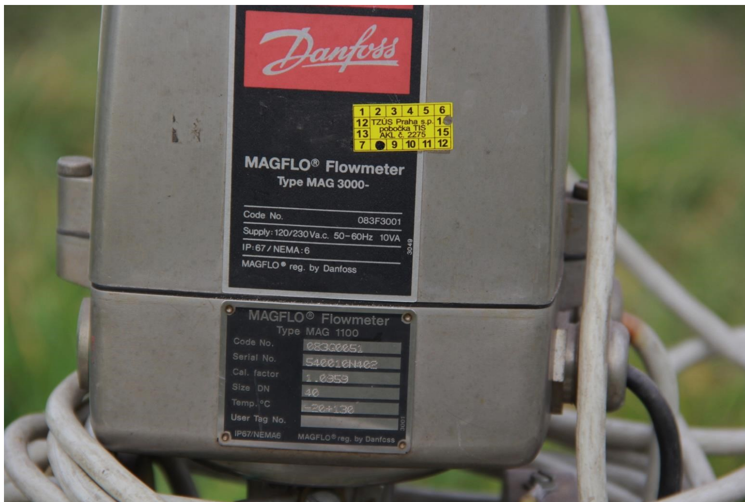
Obr. 11 – MAGLO® flowmeter MAG 1100 (DN 40), detail na štítek přístroje s poslední kalibrací
