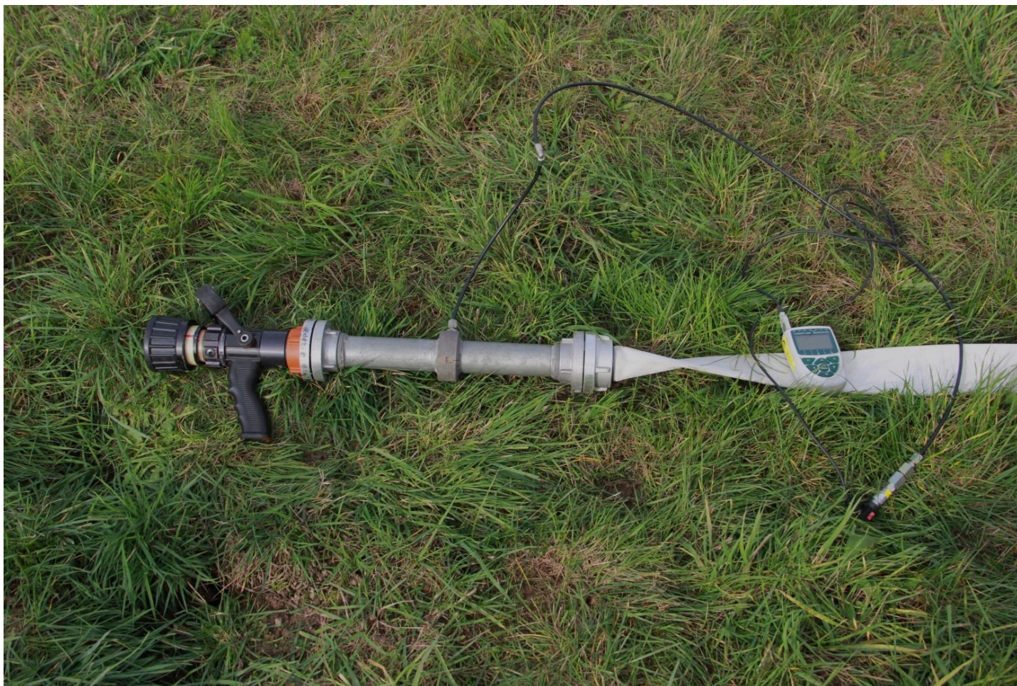
Obr. 18 – Měřicí sestava při měření přesnosti manometru čerpadla CAS
