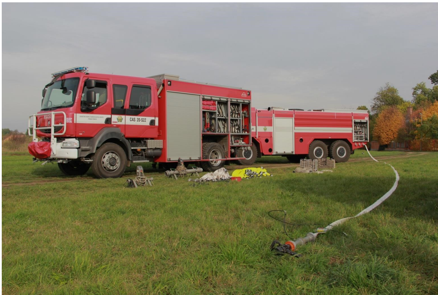
Obr. 19 – Měřicí sestava při měření přesnosti manometru čerpadla CAS
