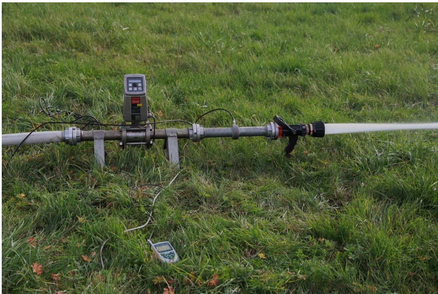
Obr. 24 – Měřicí soustava před proudnicí, tato soustava byla stejně nastavena po celou dobu měření
