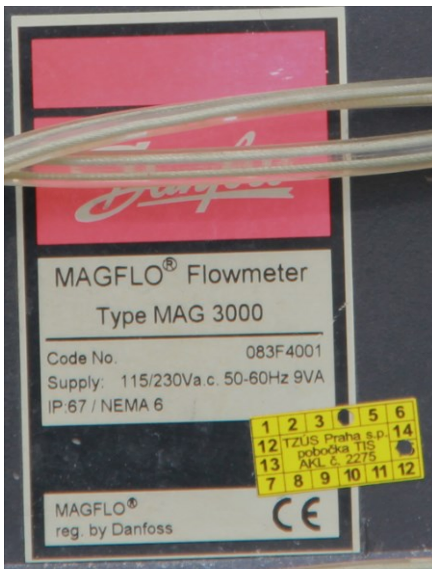
Obr. 6 – MAGLO® flowmeter MAG 3000 (DN 100), detail na štítek přístroje s poslední kalibrací
