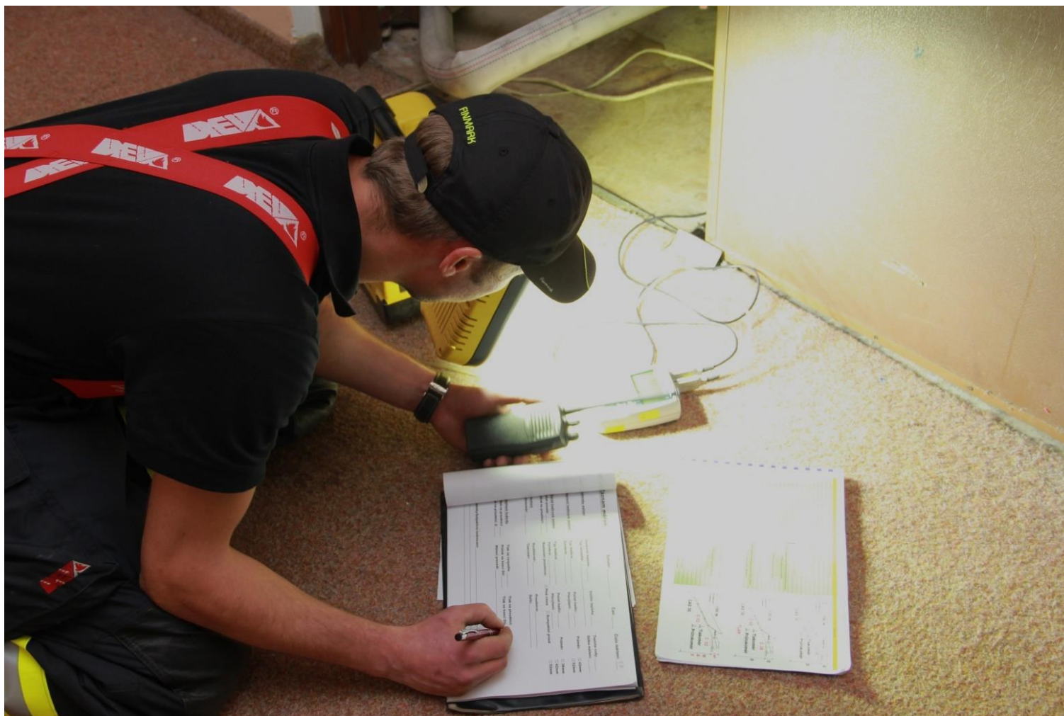
Obr. 29 – Zápis údajů při měření s výškovým převýšením v hotelu Opatov v pátém nadzemním podlaží
