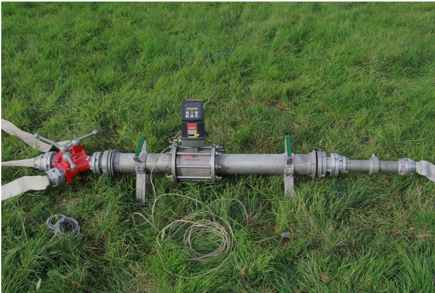
Obr. 23 – Měřicí soustava před rozdělovačem, tato soustava byla stejně nastavena po celou dobu měření
