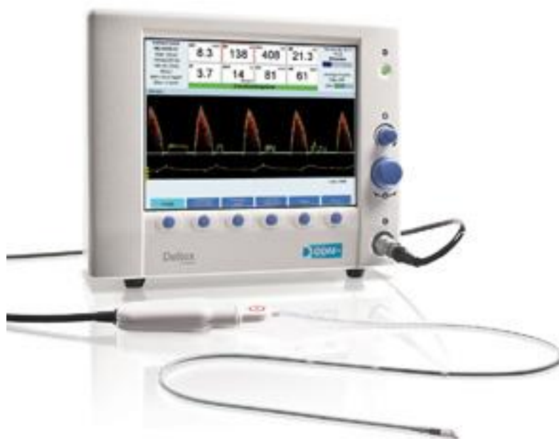
Obrázek 1: Přístroj Cardio Q-ODTM+ Esofageální dopplerovský monitor
