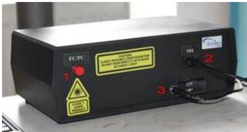
Obrázek 7.7: Pohled na čelní panel funkčního vzorku optického pH metru (1-optický konektor pro připojení vláknové sondy, 2-micro-USB konektor pro připojení k PC, 3-napájecí konektor).
