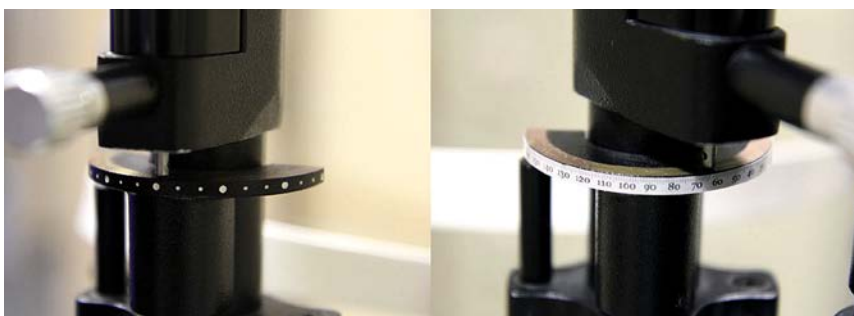
Obrázek 2.12: Stupnice definující rotaci optického řezu biomikroskopu Haag-Streit BM900. Obrázek a) bodová stupnice, b) přídavný měřící strip. [39]
