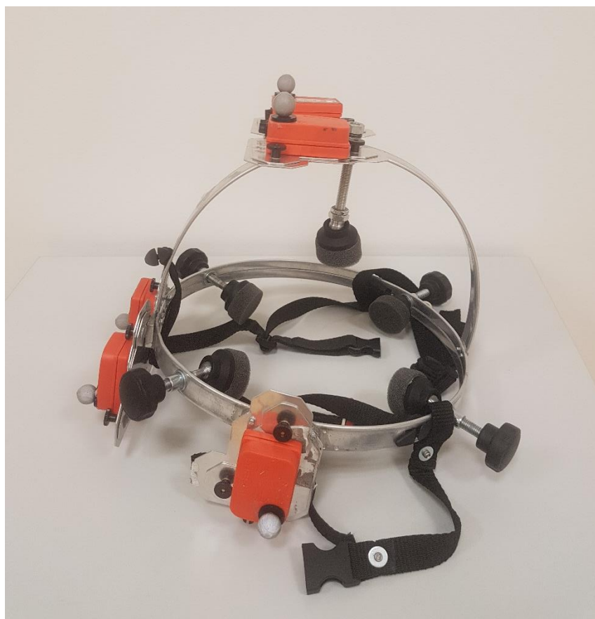
Obrázek 1.2: Zařízení pro měření pohybu vestibulárních aparátů
