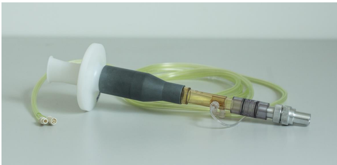
Obr. 2.4: Detailní fotografie dýchací části měřicí sestavy. Fotografie: autor.
