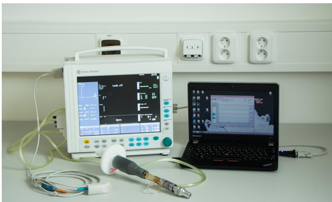
Obr. 2.3: Měřicí sestava skládající se z monitoru vitálních funkcí se spirometrickým modulem a záznamového notebooku. Fotografie: autor.
