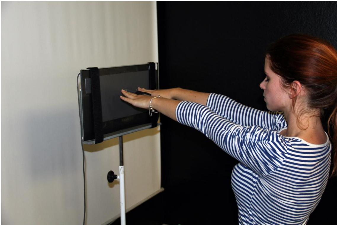
Obrázek 2.4: Měřicí soustava a počáteční pozice pacienta – předpažené ruce ve stejné výšce, zavřené oči. Pero se nedotýká tabletu a výška soustavy umožňuje dostatečný pohyb do všech stran.
