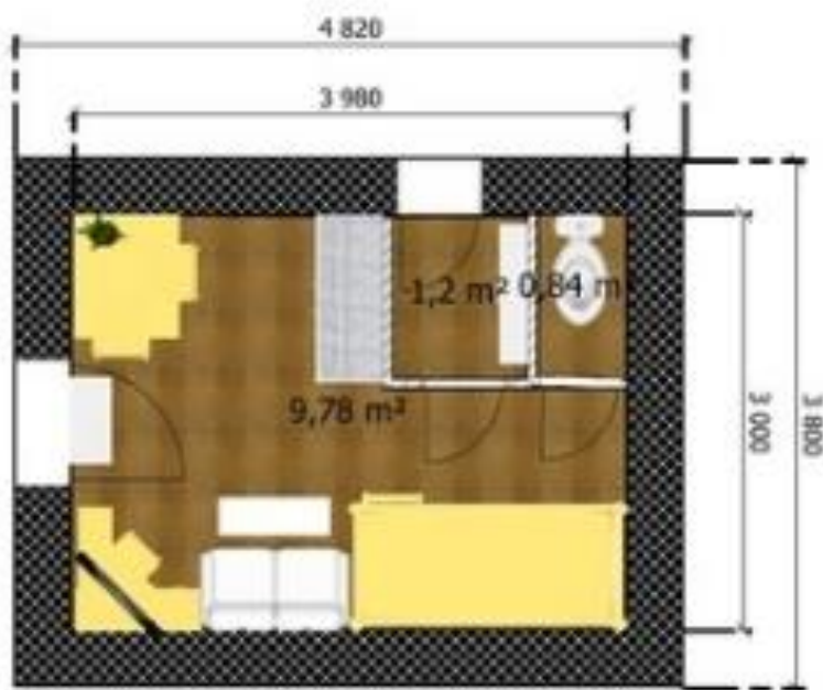
Obrázek 8 Návrh úkrytu jednoduchého typu navržený na zakázku soukr. firmou – Typ ECONOMY [29]
