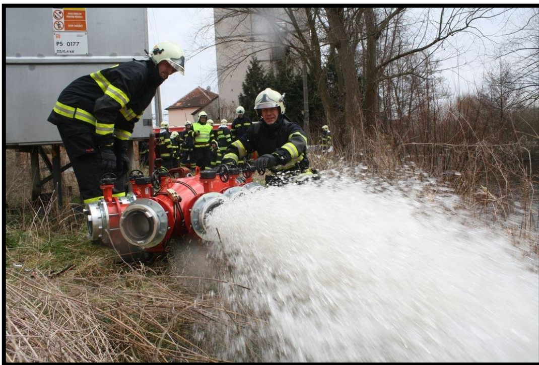
Obrázek 19 Činnost při nasazení MČS 400 při přečerpávání lagun (vlastní zdroj)
