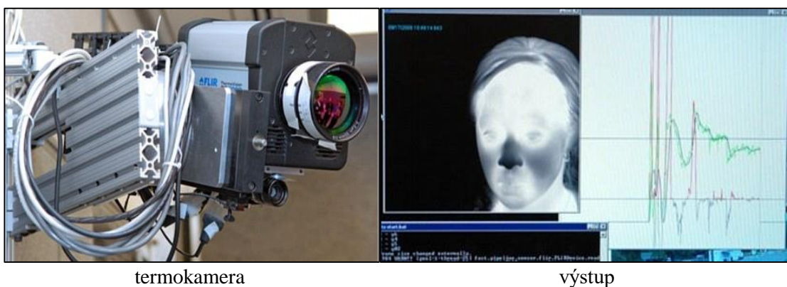
Obrázek 21 - Termokamera a počítačový výstup projektu FAST [5]
