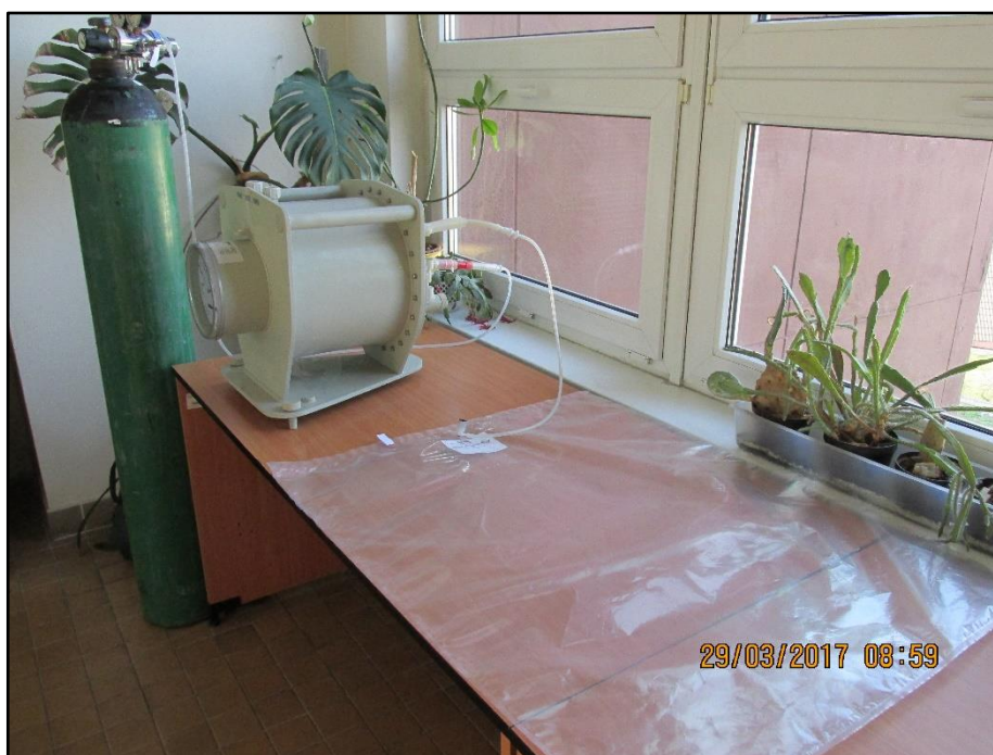
Obrázek 1 - Plnění tedlarového vaku dusíkem, zdroj vlastní.
