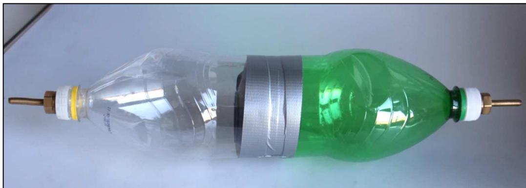
Obrázek 20 - Metoda zatěsnění kompletních ochranných filtrů Scott, zdroj vlastní.
