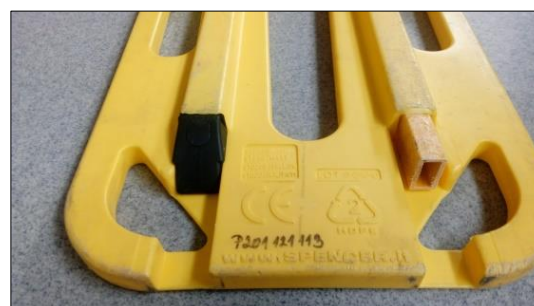
Obr. 27 - Spencer B-BAK PIN poškození zátky [zdroj vlastní]
