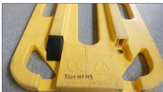
Obr. 27 - Spencer B-BAK PIN poškození zátky [zdroj vlastní]
