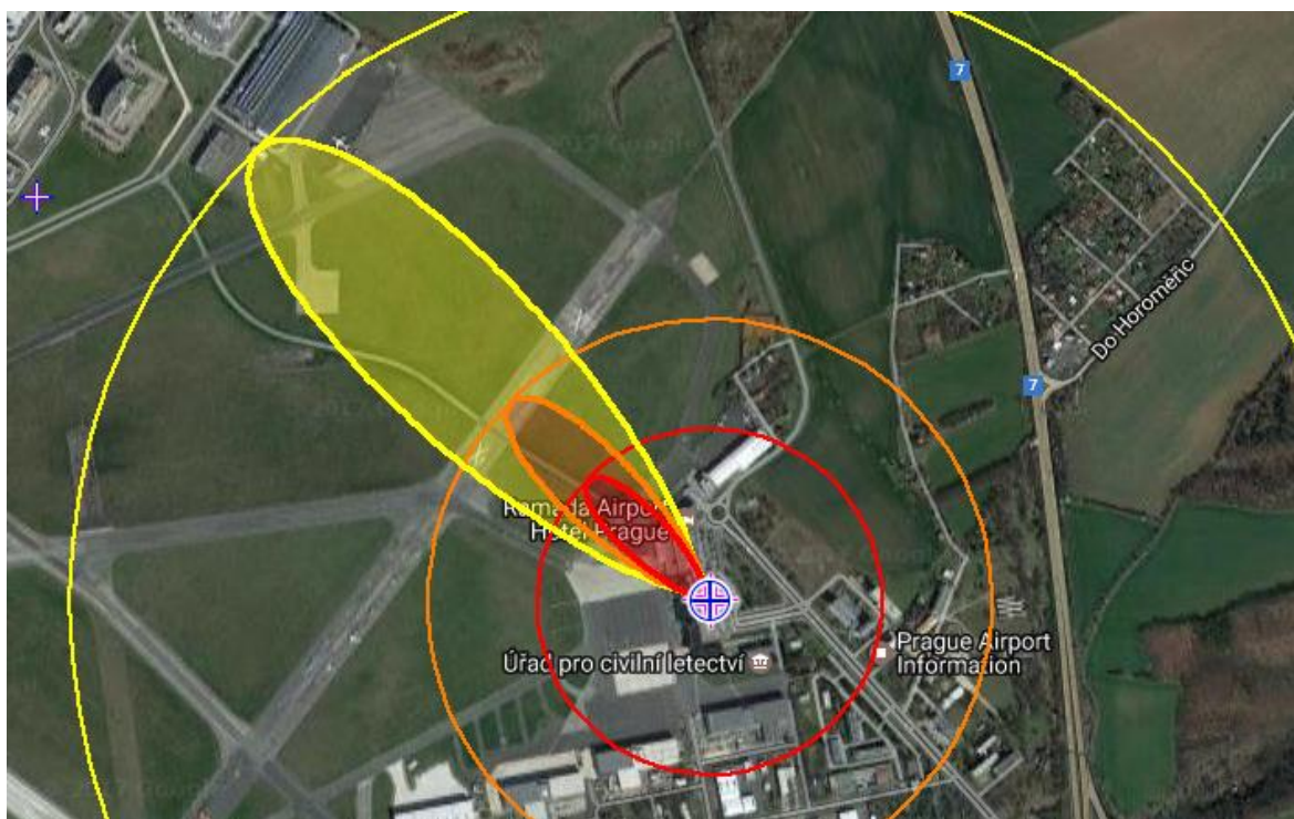
Obrázek 8 Meze detekce prostředků DETEHIT a DT-11, zóna AEGL-3 [41 – upraveno autorem]
