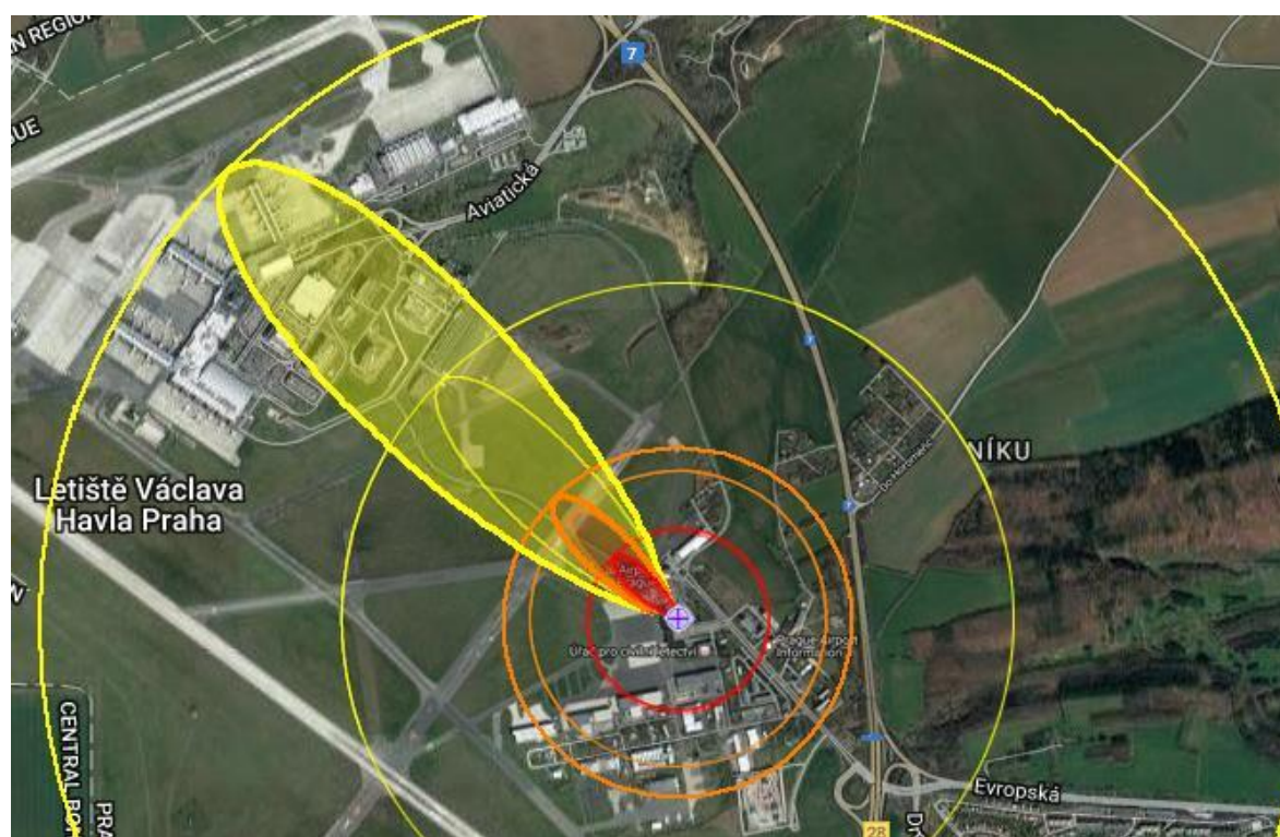
Obrázek 9 Grafické znázornění zón nebezpečnosti a zón citlivosti (mezi detekce) jednoduchých detekčních prostředků (pro sarin) [41 – upraveno autorem]
