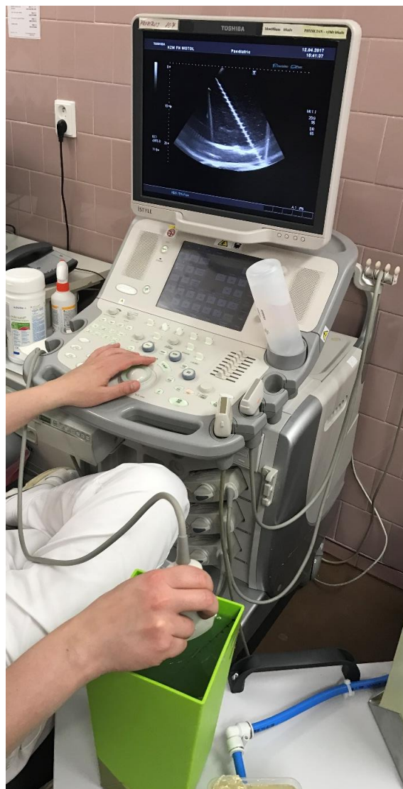
Obrázek 8.2: Proměrování hloubkového fantomu pomocí diagnostického UZ firmy Toshiba Aplio MX konvexní sondou s frekvencí 3,5 MHz [40].
