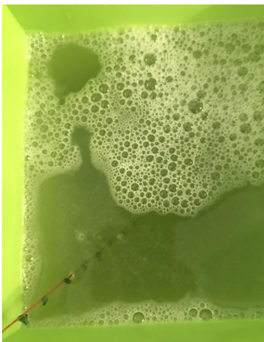
Obrázek 5.10: Nádoba s měřící stupnicí čerstvě zalitá želatinou [40].
