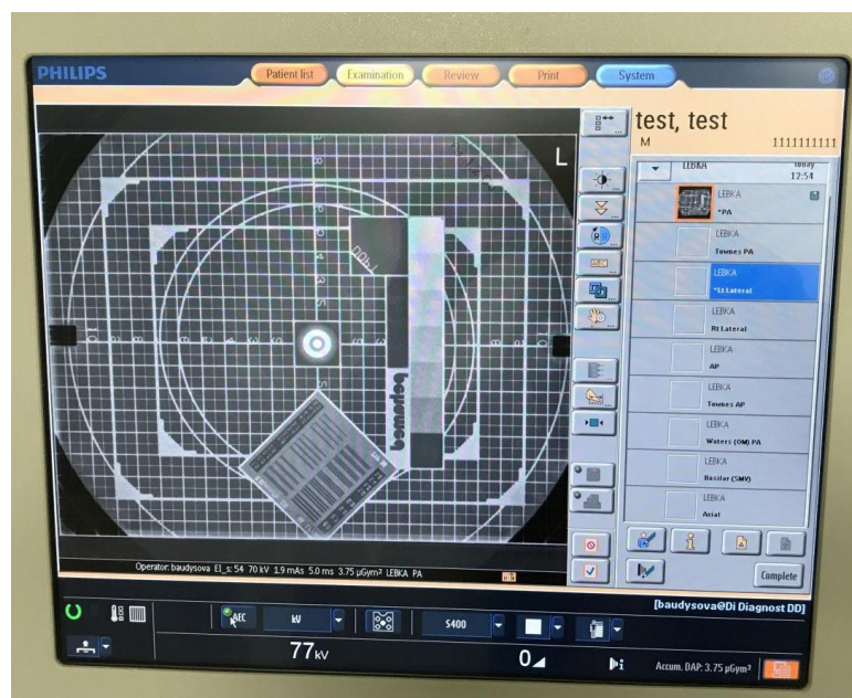
Obrázek 8.1: Ukázka testu při proměřování fantomu na rentgenu DigitalDiagnost od firmy Philips [40].
