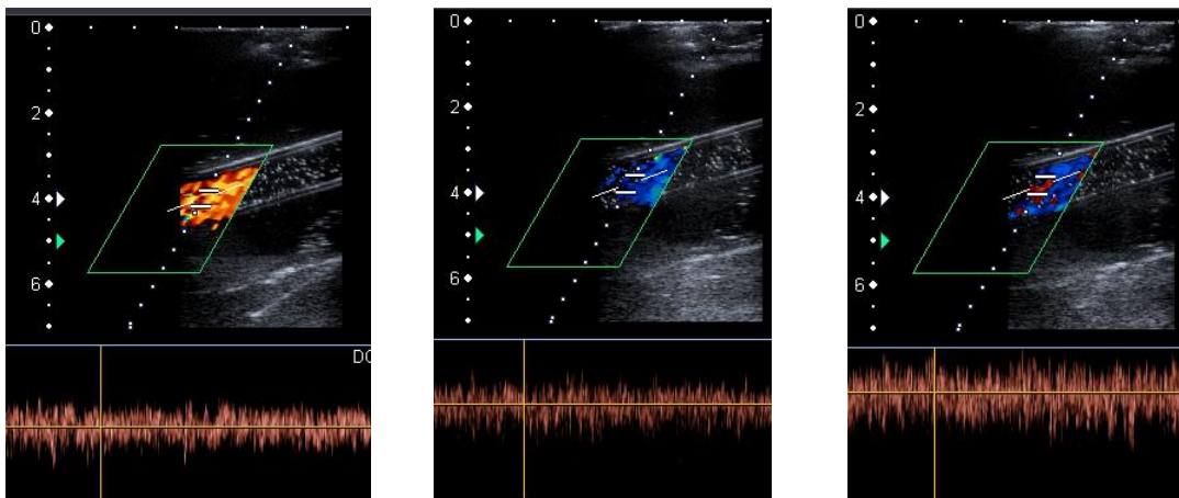
Obrázky 8.8: Snímky z měření číslo 6, 8 a 12 na diagnostickém ultrazvuku Aplio MX, kdy je gantra nastavena na 4 mm, úhel na 55°. Režim pro vyšetření je Carotid a měřená střední hodnota rychlosti průtoku je 86 cm/sec, 105 cm/sec a 128 cm/sec.
