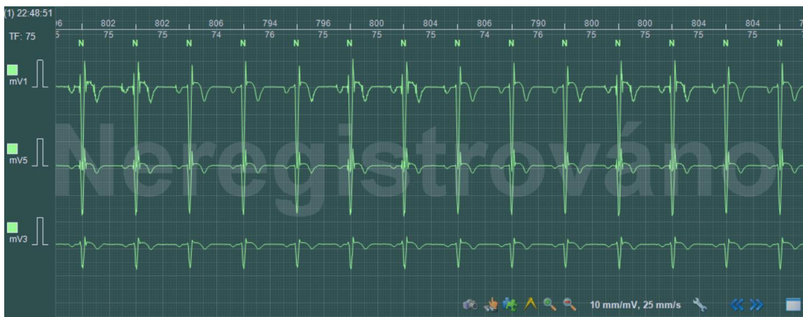
Obr.7.8: Odfiltrovaný signál po aplikaci 50 Hz filtru
