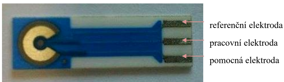
Obr. 2.2: Elektrochemický senzor AC1.W*.RS (BVT Technologies), skutečný rozměr senzoru je 25 \times 7 mm [zdroj: autor]
