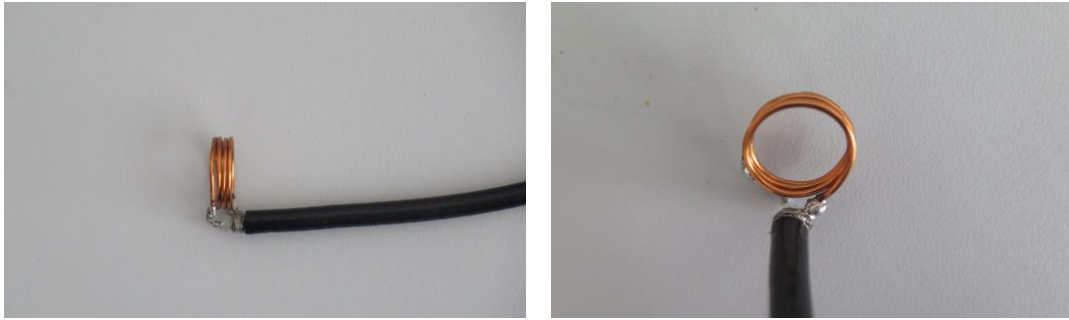
Obr. 4.9: Vzduchová cívka pro přímé měření intenzity magnetického pole.
