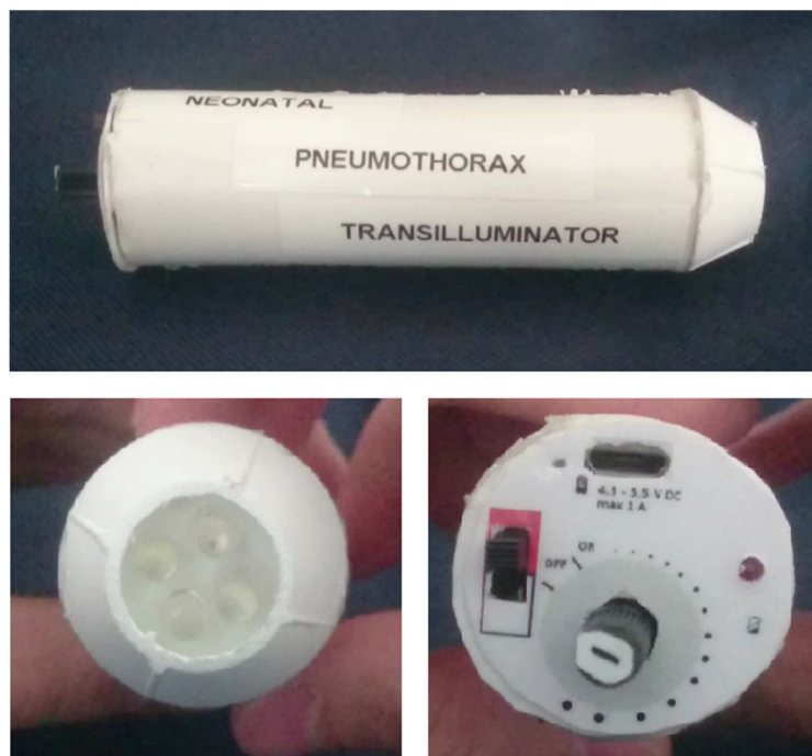
Obrázek 4.15: Fotografie realizovaného prototypu novorozeneckého transiluminátoru z bočního, předního a zadního pohledu
