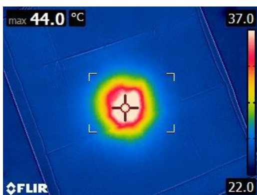
Obrázek 54: Záznam pro kombinaci světél TruLight v rozsahu 22-37 °C s upravenou podložkou (autorský obrázek)
