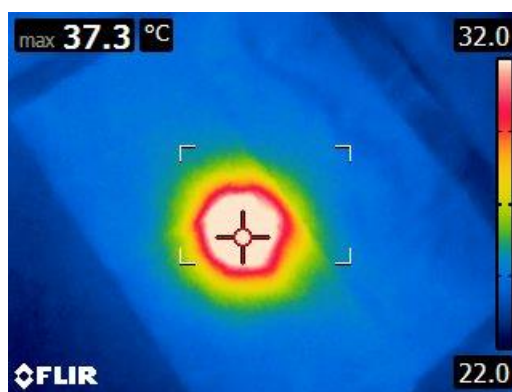
Obrázek 31: Záznam pro kombinaci světél Hanaulux v rozsahu 22-32 °C s upravenou podložkou (autorský obrázek)
