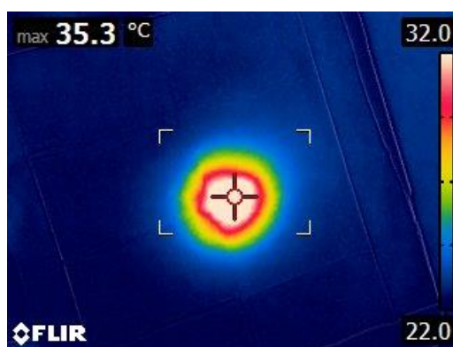
Obrázek 59: Záznam pro malé světlo Steris Xled v rozsahu 22-32 °C s upravenou podložkou (autorský obrázek)
