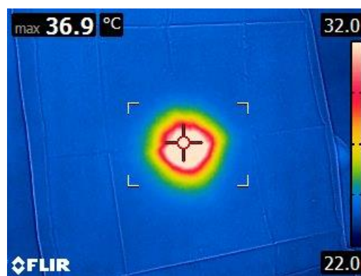
Obrázek 71: Záznam pro světlo Mach LED v rozsahu 22-32 °C s upravenou podložkou (autorský obrázek)
