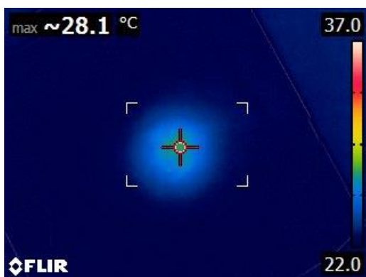
Obrázek 58: Záznam pro malé světlo Steris Xled v rozsahu 22-37 °C s upravenou podložkou (autorský obrázek)
