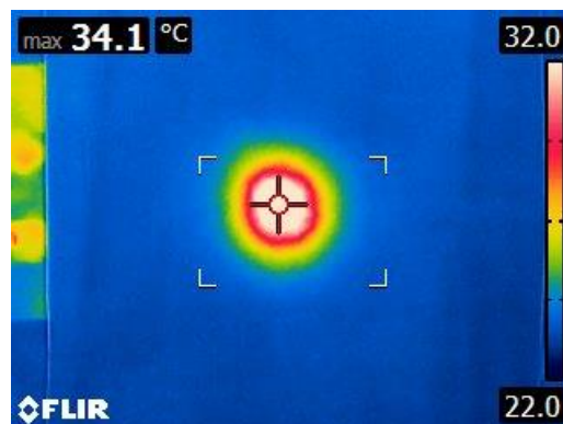
Obrázek 75: Záznam pro kombinaci světél Mach LED v rozsahu 22-32 °C s upravenou podložkou (autorský obrázek)
