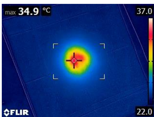
Obrázek 38: Záznam pro velké světlo Maquet v rozsahu 22-37 °C s upravenou podložkou (autorský obrázek)
