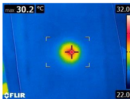
Obrázek 71: Záznam pro světlo Mach LED v rozsahu 22-32 °C s upravenou podložkou (autorský obrázek)
