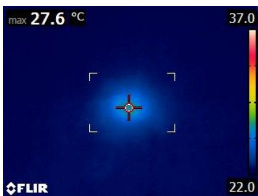
Obrázek 26: Záznam pro velké světlo Hanaulux v rozsahu 22-37 °C s upravenou podložkou (autorský obrázek)
