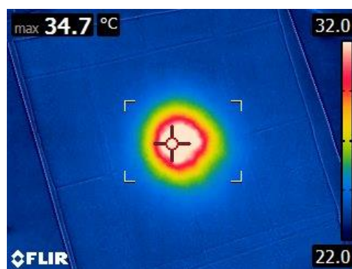
Obrázek 39: Záznam pro velké světlo Maquet v rozsahu 22-32 °C s upravenou podložkou (autorský obrázek)
