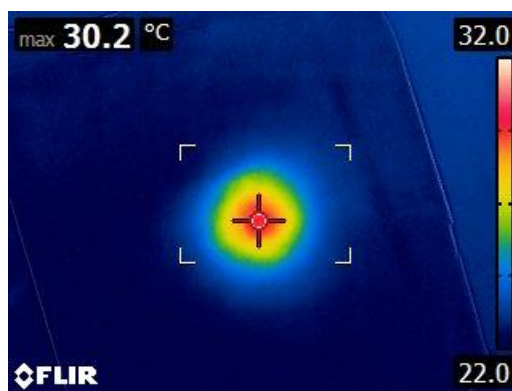
Obrázek 63: Záznam pro velké světlo Steris Xled v rozsahu 22-32 °C s upravenou podložkou (autorský obrázek)
