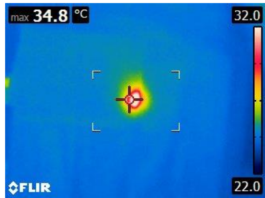
Obrázek 13: Záznam pro malé světlo MarLux v rozsahu 22-32 °C s rouškou (autorský obrázek)
