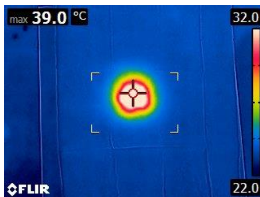
Obrázek 49: Záznam pro malé světlo TruLight v rozsahu 22-32 °C s rouškou (autorský obrázek)
