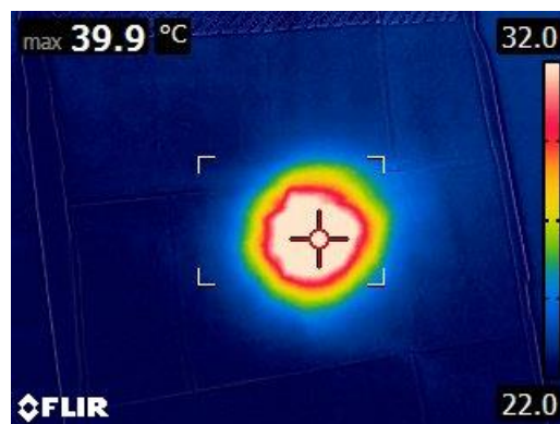
Obrázek 65: Záznam pro velké světlo Steris Xled v rozsahu 22-32 °C s rouškou (autorský obrázek)
