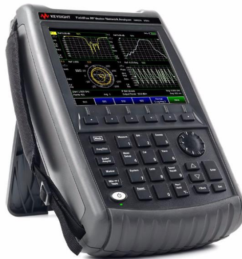
Obrázek 2.1: Vektorový analyzátor obvodů KEYSIGHT FieldFox N9923A [22].
