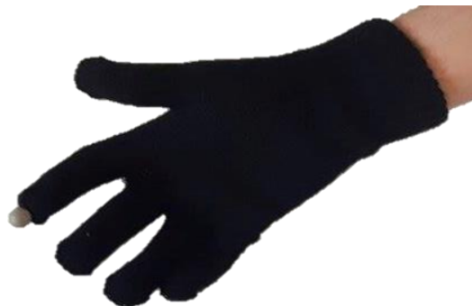
Obrázek 4.4: Vyfocené řešení umístění markeru při měření kinetického třesu
