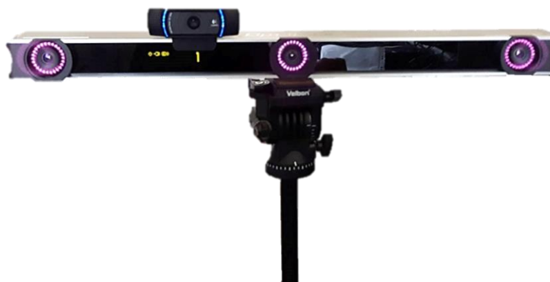
Obrázek 5.2: Výsledné uspořádání kamery pro videozáznam a kamerového systému Optitrack na stativu (foto autora)
