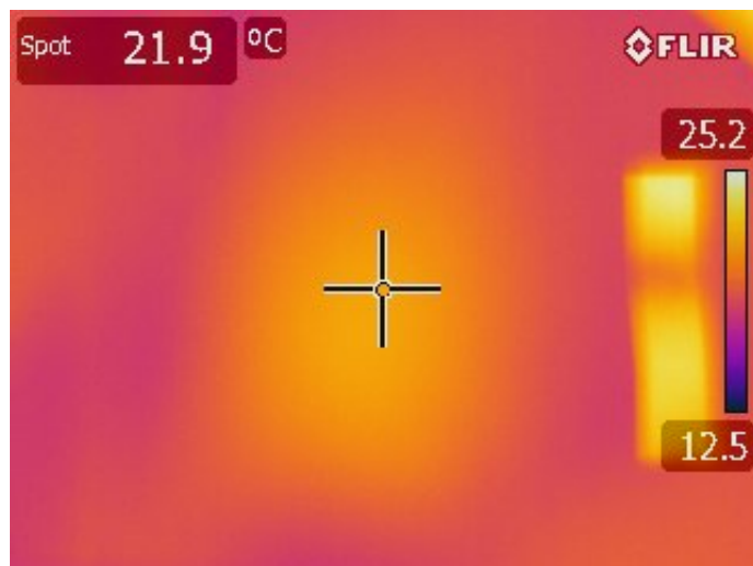
Obr. 3.12: Rozložení teplotního pole po 1cm řezu horní vrstvy po snímání termovizní kamerou.
