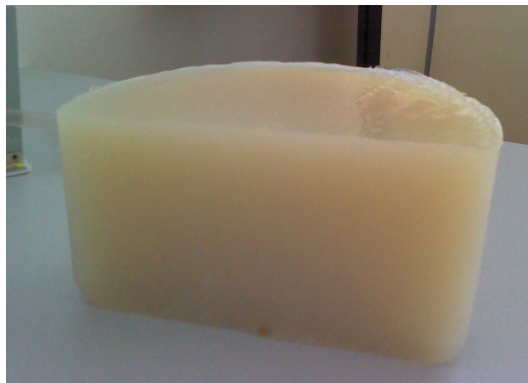
Obr. 2.8: Část fantomu po svislém řezu před snímáním termovizní kamerou.
