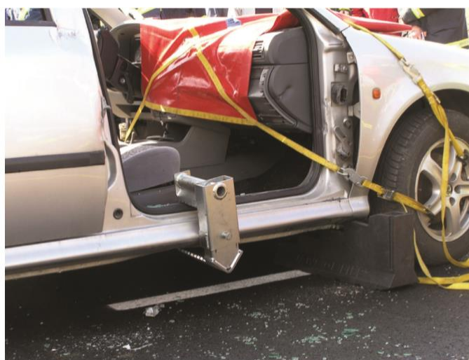
Obrázek 46 - Nasazení zachycovače airbagu pro spolujezdce [32]
