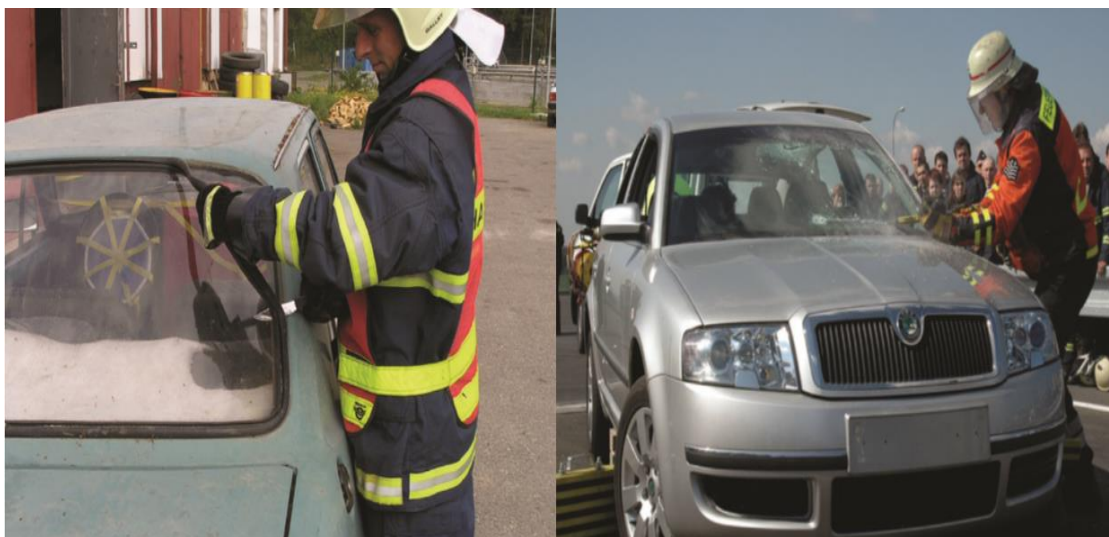
Obrázek 44 - Odstranění vrstveného skla staršího vozidla (vlevo), modernějšího (vpravo) [32]
