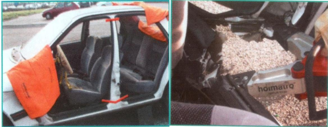
Obrázek 49 - Kompletní odstranění dveří (vlevo), odtažení zbytku B sloupku (vpravo) [26].
