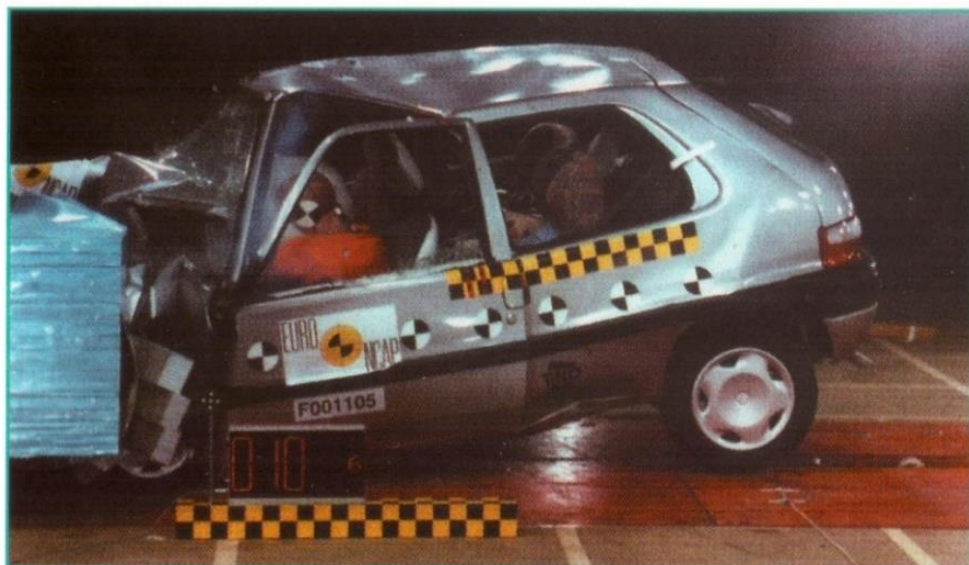
Obrázek 54 - Čelní náraz do překážky při testování v Euro NCAP [26]
