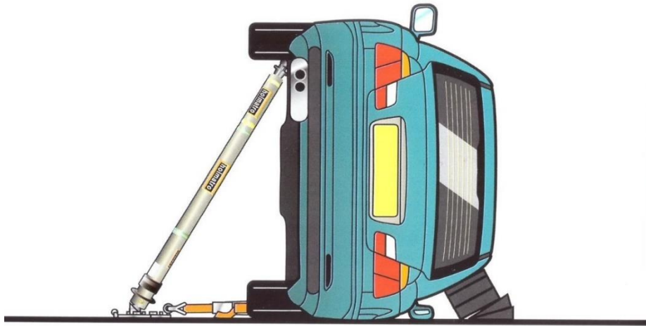
Obrázek 41 - Stabilizace vozidla na boku [26]
