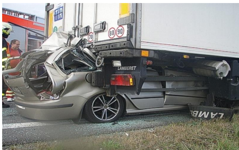
Obrázek 57 - Náráz vozidla do přívěsu [36]
