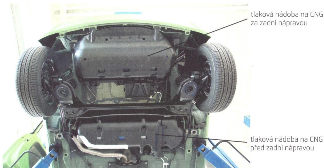
Obrázek 59 - Tlakové nádoby na CNG s kryty pod podlahou zadní části vozidla [37]
