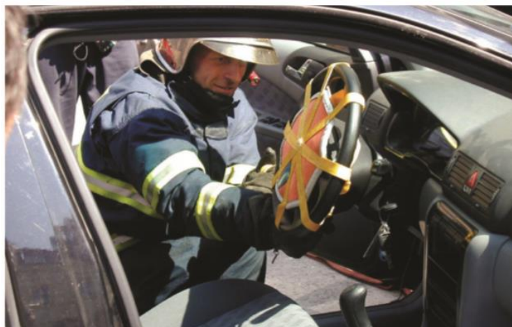
Obrázek 45 - Nasazení zachycovače airbagu pro řidiče [32]
