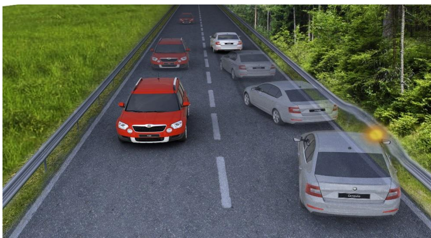
Obrázek 25 - Příklad aktivace multikolizní brzdy [19]
