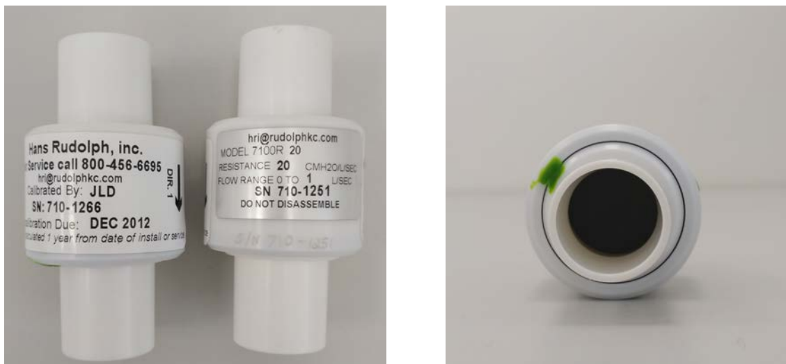
Obr. 1.2: Příklad lineárního rezistoru o velikosti 5 a 20 cm H 2 O·s/L (Hans Rudolph, inc., Shawnee, Kansas, USA), který je vyroben pomocí odporového síta. Oba vyobrazené lineární rezistory byly v této práci použity.
