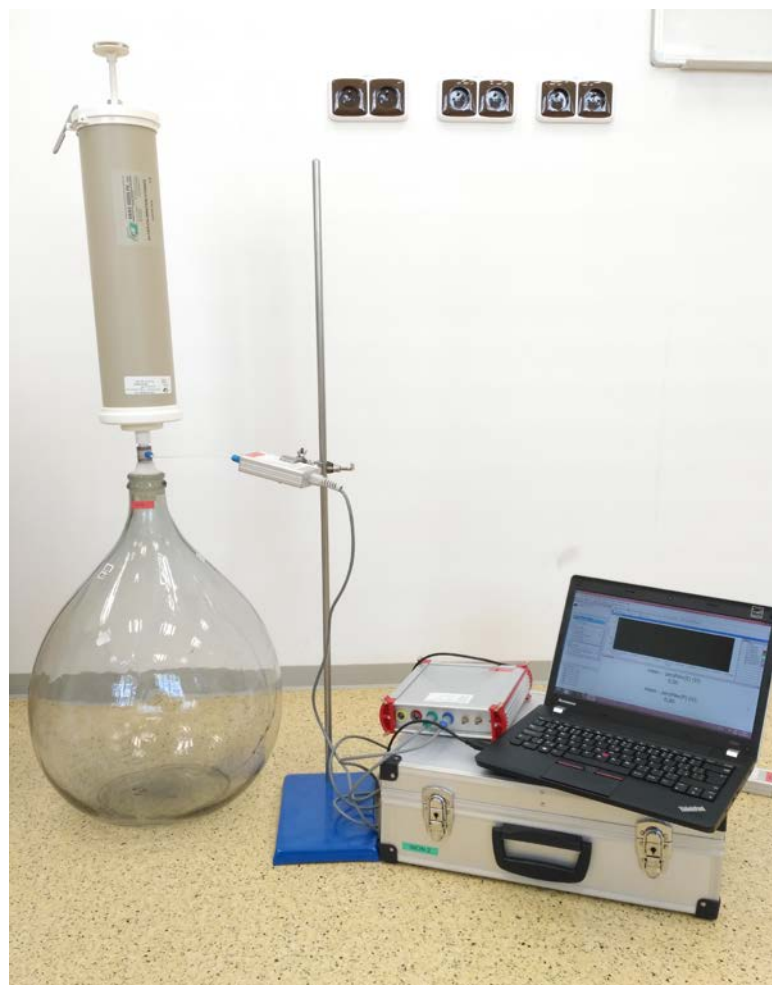
Obr. 2.2: Sestava pro měření poddajnosti referenčních modelů respirační soustavy s napojeným senzorem pro kontinuální monitorování tlaku.
