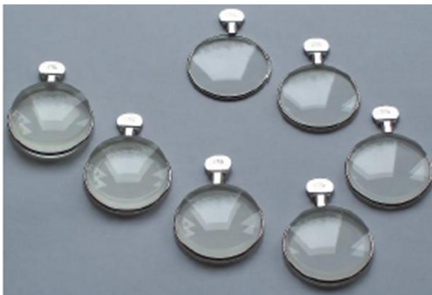
Obrázek 16: Sada anizeikonických čoček se zvětšení 1-7% [18]
