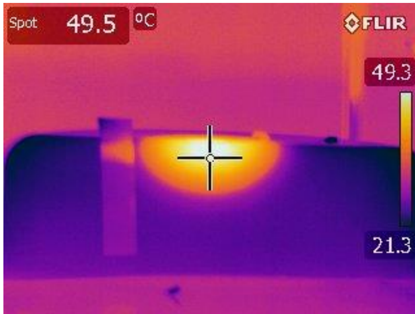
Obr. 5.3.1: Teplotní pole po 5 minutách zahřívání spirálovým aplikátorem. Průřez středem agaru. Výsledný obrázek v infračerveném světle pomocí termokamery. Obdélník po levé straně teplotního pole je vysoká 5 cm.
