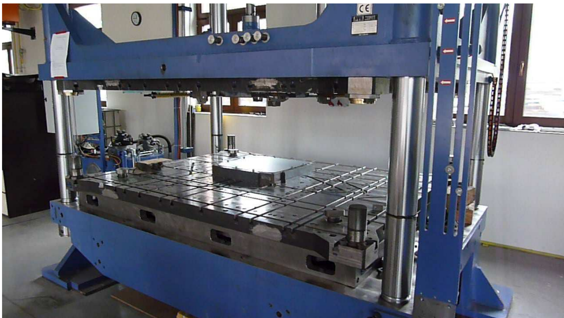
Obr. 7 - Pracoviště lisování – Hydraulický lis osazený tažníkem a tažnicí
