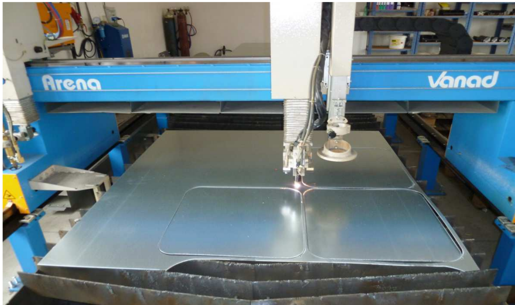
Obr. 6 – Pracoviště vypalování - Plazmový CNC vypalovací stroj
