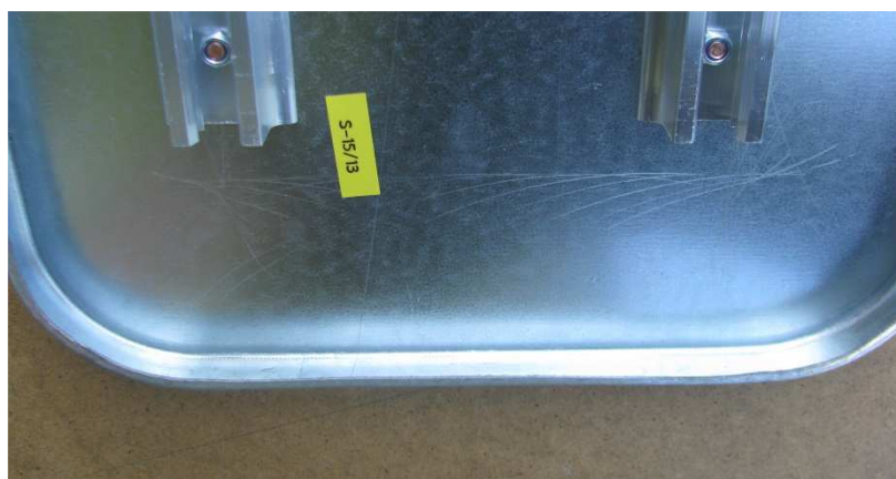
Obr. č. 4 – Štít dopravní značky s dvojitým ohybem
