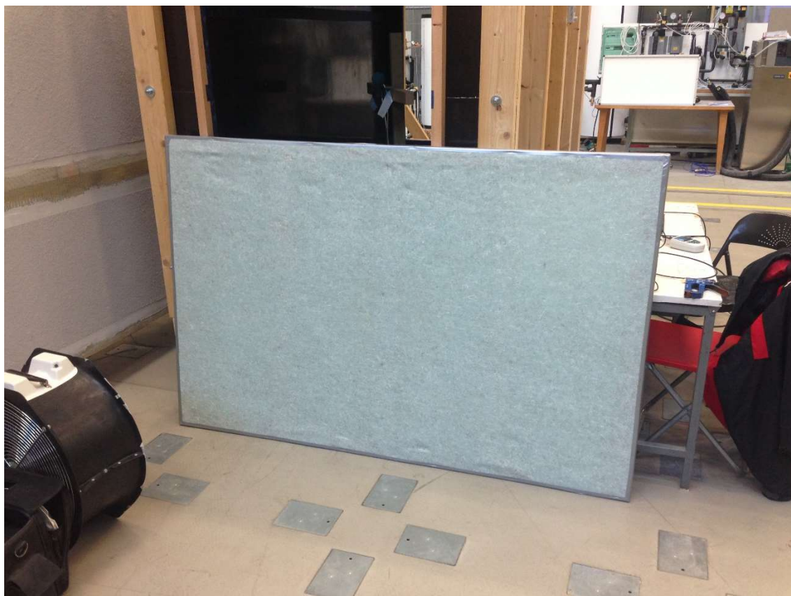
Příloha 17: Upravený difuzor; geotextilie na rámu
