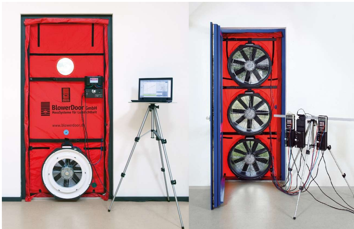
Obrázek 2: Umístění ventilátorů systému blower door [5]
