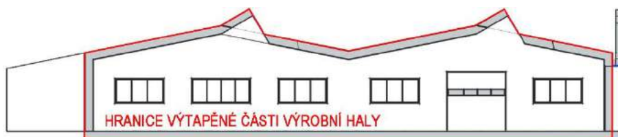
Obr. 41 - Systémová hranice vytápěné části stávající výrobní haly
