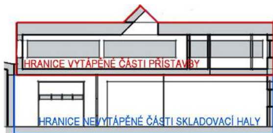
Obr. 43 - Systémová hranice vytápěné a nevytápěné části přístavby
