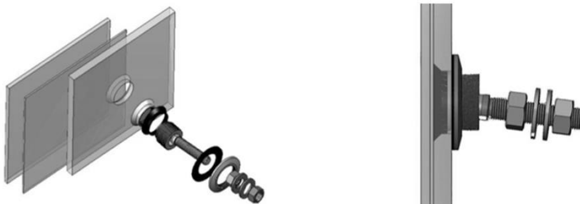
Obr. 18: Spoj s vloženou hlavou skrutky [10]
