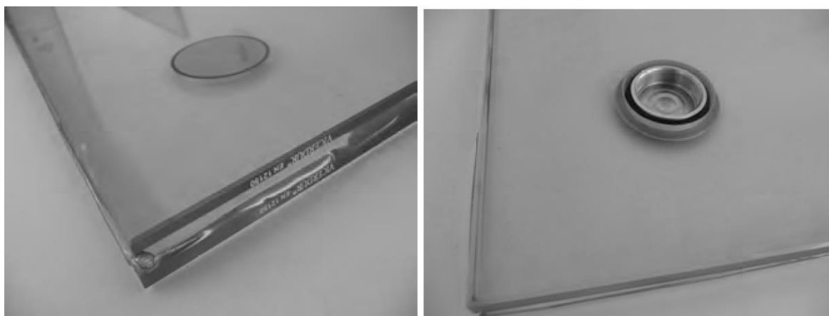
Obr. 21: Vzorka po teste na vlhkosť [11]
