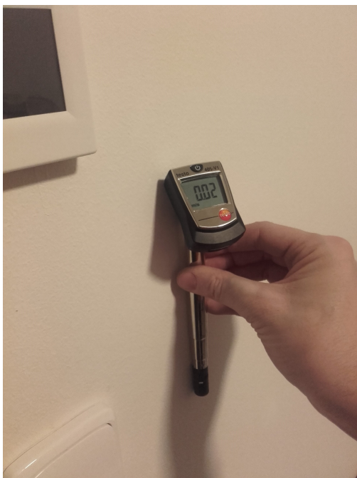
Ilustrace 10: Bez netěsnosti, hodnota blízka 0 m/s
