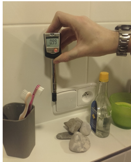
Ilustrace 9: Detekovaná netěsnost - vypínač v koupelně
