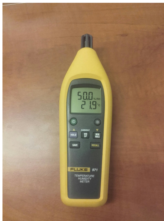
Ilustrace 30: Měřič teploty a vlhkosti Fluke 971, (převzato z [4])
