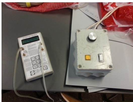
Ilustrace 14: Vlevo přístroj pro měření tlaků a objemových toků, vpravo regulátor otáček ventilátoru [4]
