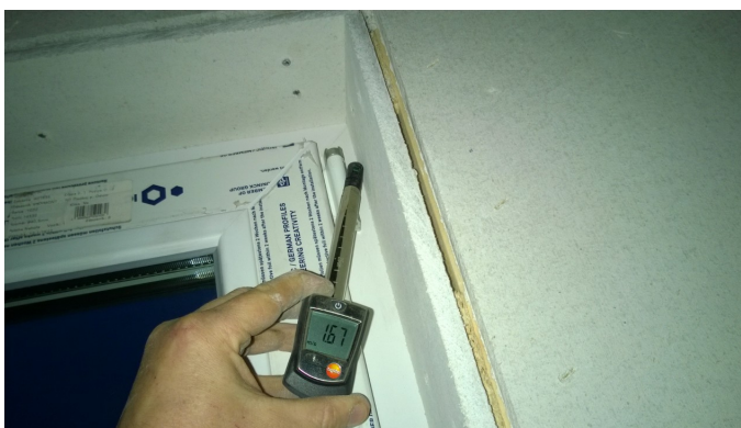
Ilustrace 15: Použití anemometru pro detekci netěsností (převzato z [27])
