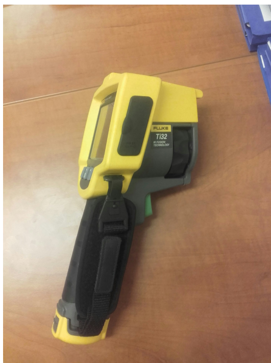
Ilustrace 29: Termokamera Fluke Ti32, (převzato z [4])
