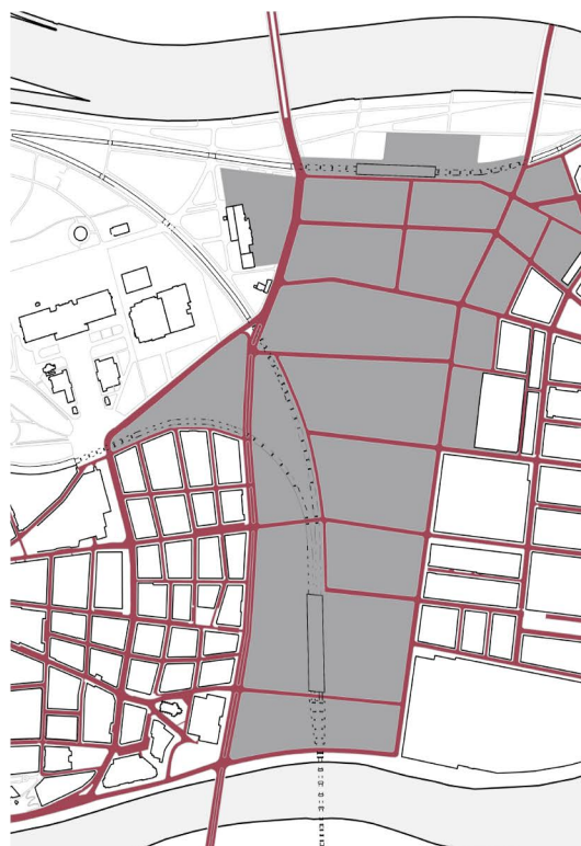
Komunikační propojení a vytvoření ostrovů, které slouží jako platforma pro novou strukturu. Všechny nově navržené komunikace jsou s 2 pruhy, pouze Bubenská má 4.
