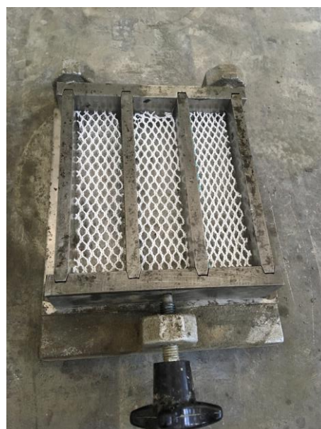
Obr. 3.6 Forma s vloženou pleteninou
