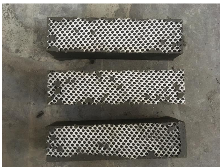
Obr. 3.30 Vzorek č.5 – D0101-01 po odbednění s viditelnou pleteninou.
