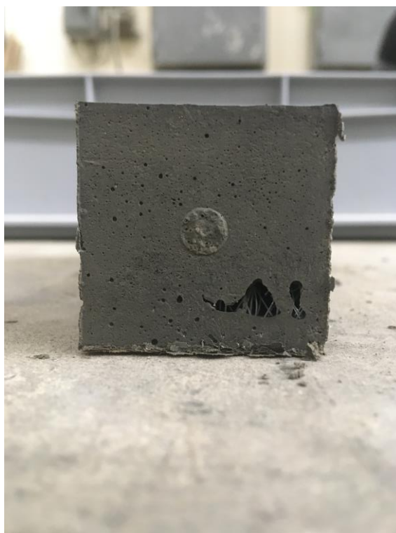
Obr. 3.26 Vzorek č.3 – D0020-01 po odbednění s viditelnými vlákny pleteniny.
