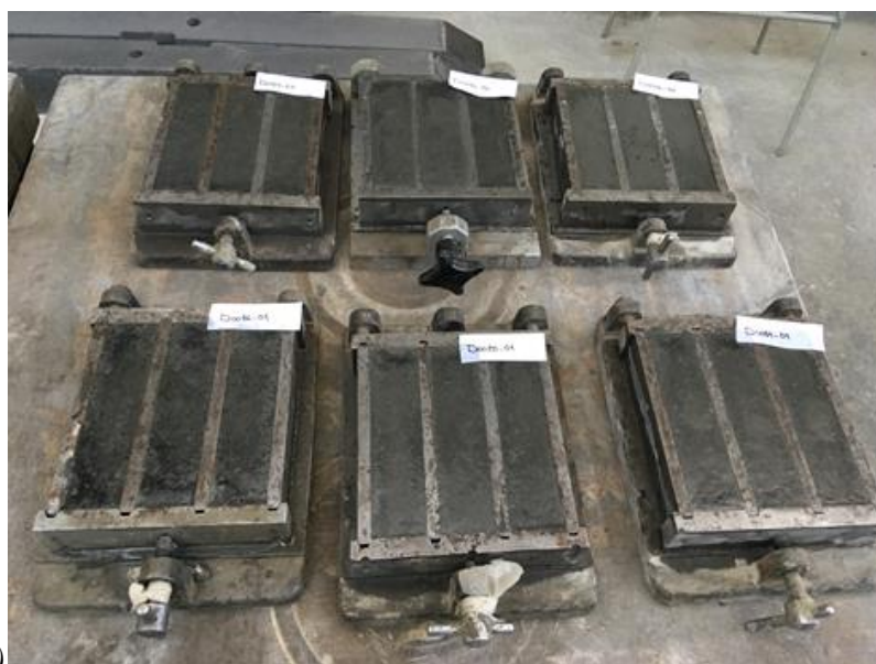
Obr. 3.7 Vzorky po zhutnění.
