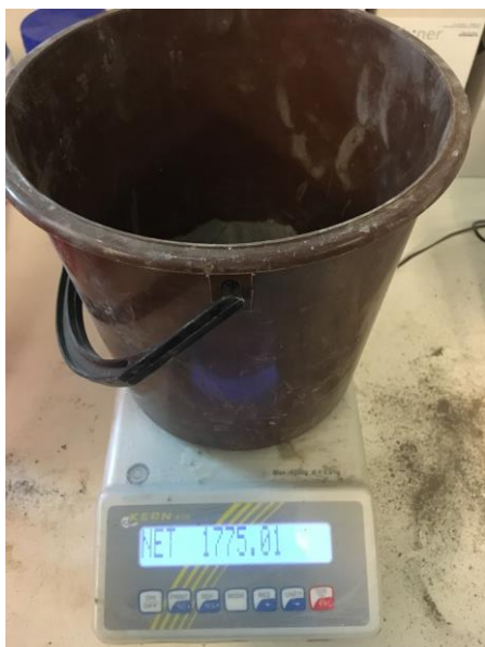
Obr. 3.3 Vážení UHPC směsi
