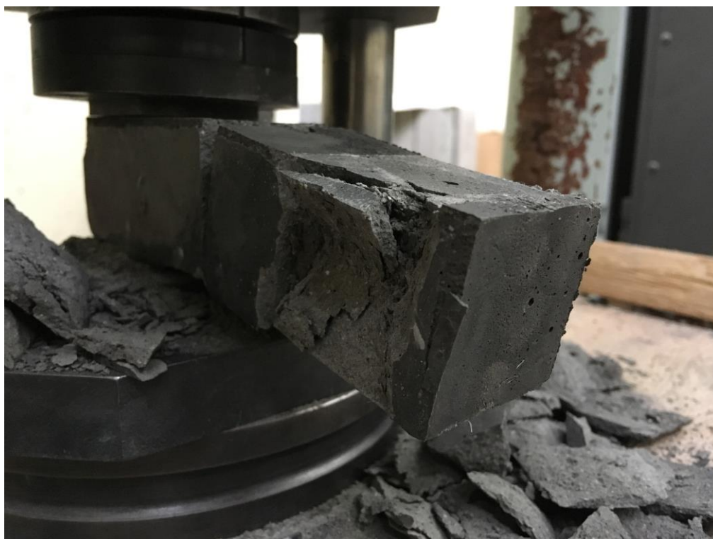
Obr. 3.17 Uložení vzorku č.1 – D0054-01 v lisu při zkoušce pevnosti v tlaku.
