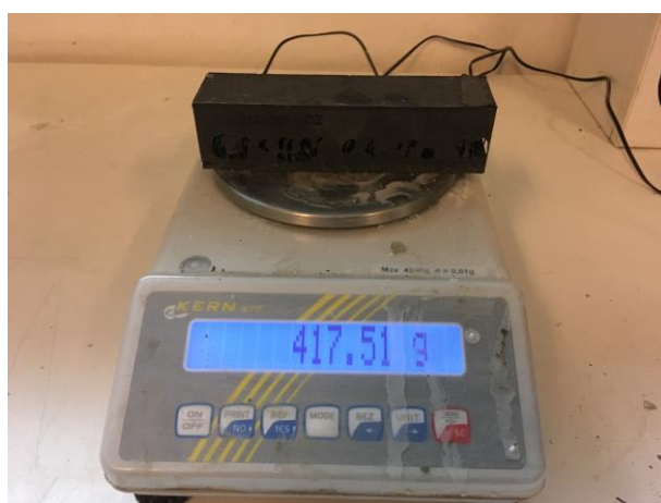
Obr. 3.13 Vážení vzorku č.6 – D0030-02.
