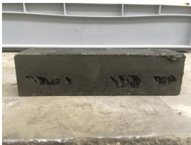
Obr. 3.10 Nedokonalé protečení u vzorku č.6 – D0030-02.
