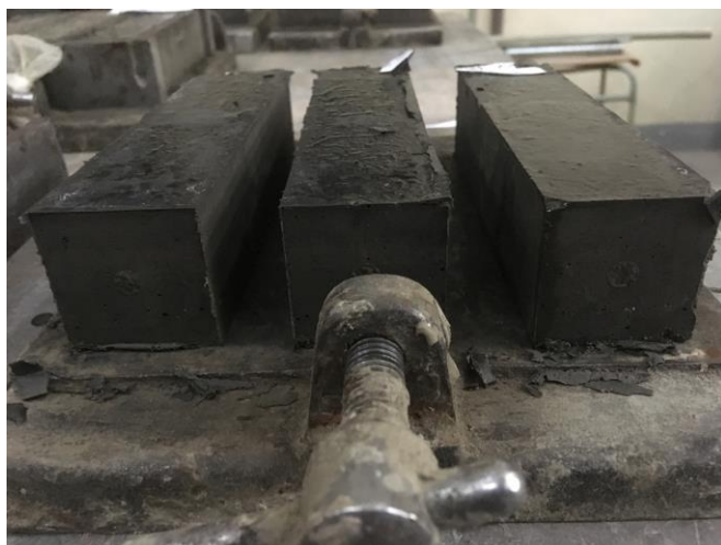
Obr. 3.8 Vzorek č.1 – D0054-01 po odbednění.
