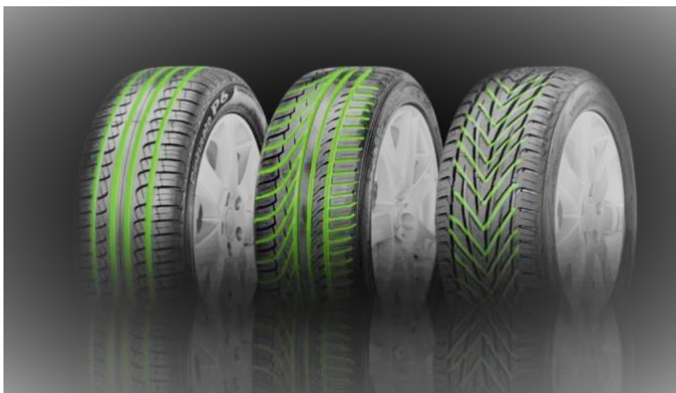
Obrázek 1.4: Typy dezénu (zleva symetrický, asymetrický a směrový)[3]
