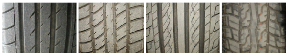
Obrázek 2.5: Druhy vzorků pneumatiky (zleva vertikální, horizontální, diagonální a nepravidelný)[5]
