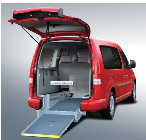
Obrázek 11 Obrázek 2 API - úprava VW Caddy - vyklopená rampa (zdroj: www.apicz.com )
