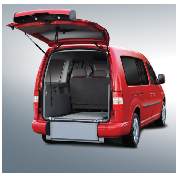
Obrázek 12 API - úprava VW Caddy - zaklopená rampa (zdroj: www.apicz.com )
