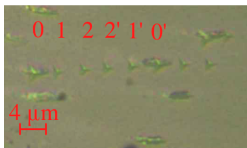
Tabulka 5.2 & Obrázek 5.7: Hodnoty tvrdosti (H) a redukovaného modulu pružnosti ( E_r ) determinované pro jednotlivé indenty matice č. 4.
