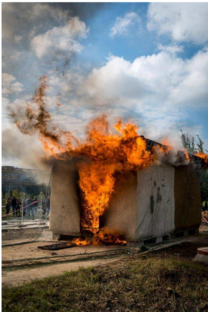
Obr. 16: Plně rozvinutý požár při požární zkoušce experimentálního objektu – 18. minuta
