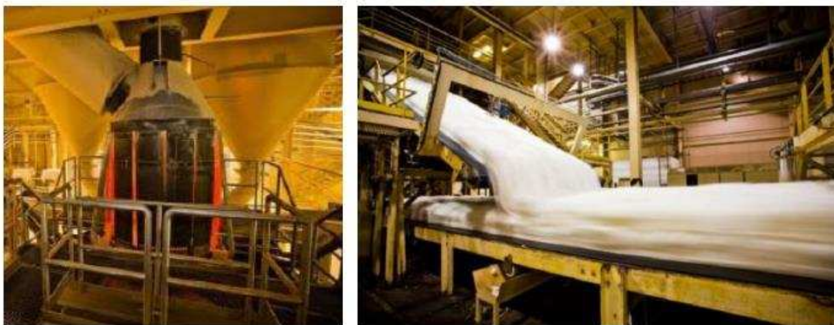
Obr. 7: a) Tavení surovin v kupolové peci; b) Vrstvení materiálu na pohyblivý pás
