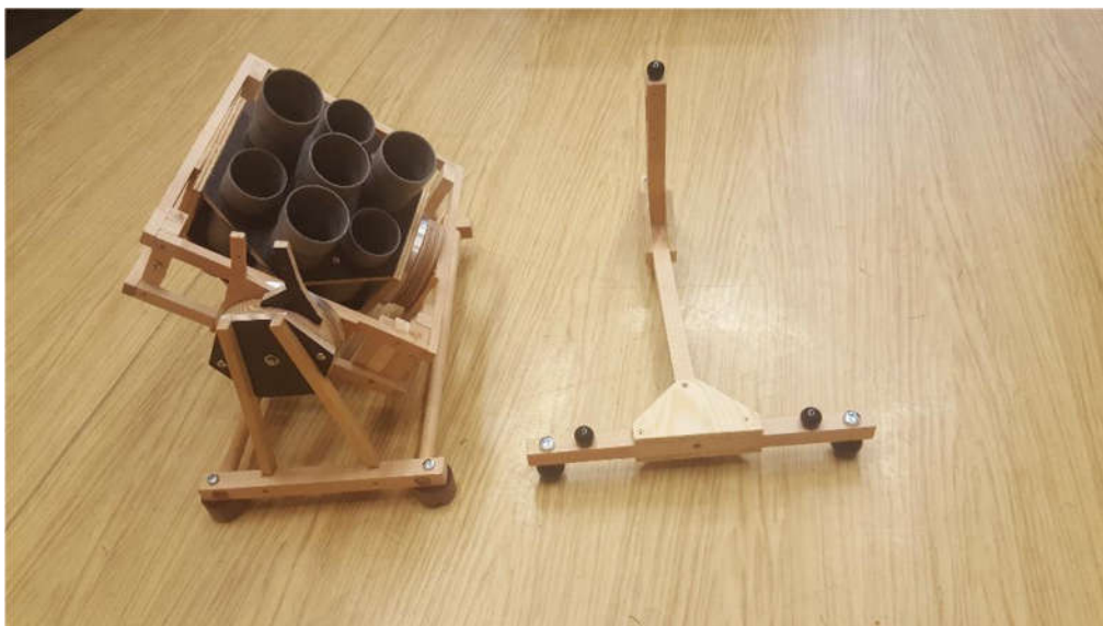
Obr. 24: Montáž altitude-altitude s paralaktickou podložkou
