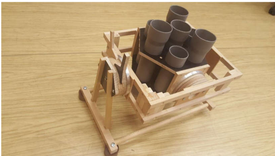
Obr. 23: Montáž typu altitude-altitude
