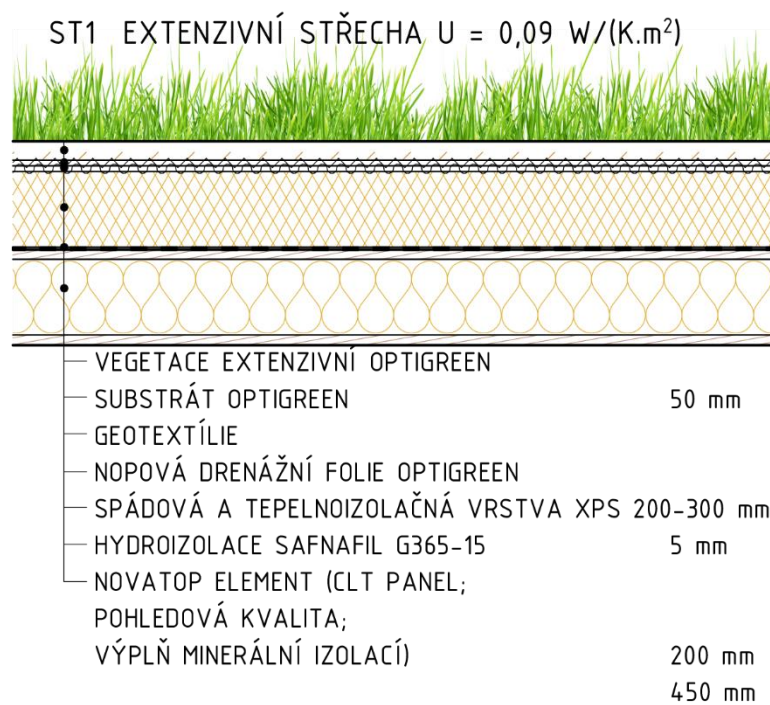
Obr. 28: Skladba extenzivní střechy ST1 – M1:20
