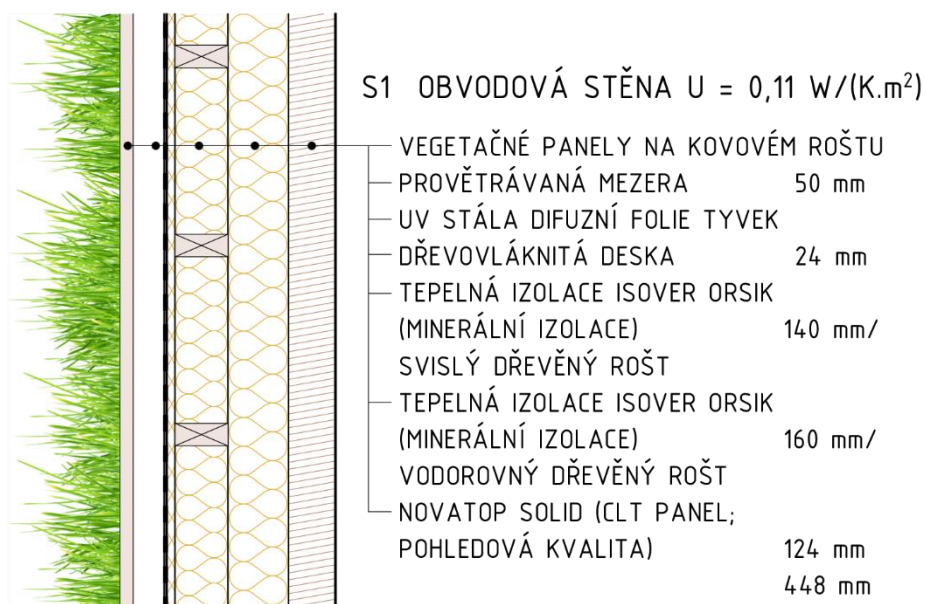
Obr. 26: Skladba obvodové stěny S1 – M1:20
