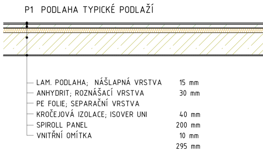
Obr. 20: Skladba podlahy typické podlaží – M1:20
