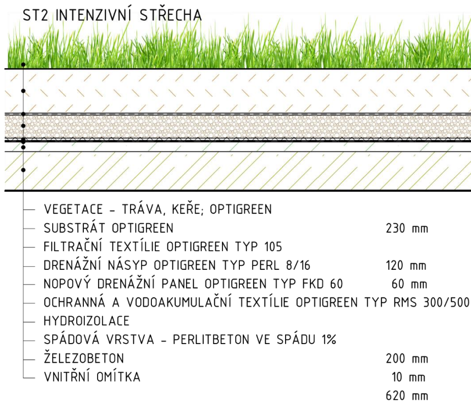
Obr. 14: Skladba střechy nad garáží – M1:20
