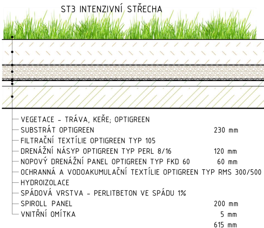
Obr. 30: Skladba intenzivní střechy ST3 – M1:20
