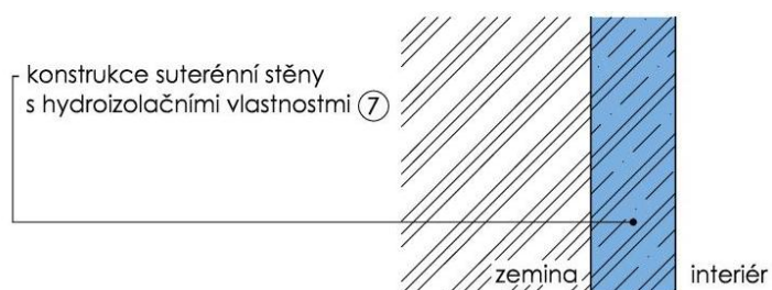
Obr. 3.13 Suterénní stěna D 2.1. bílá vana
