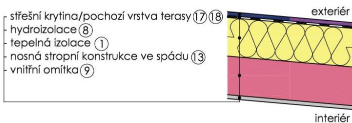
Obr. 3.4 Střecha se stropem ve spádu
