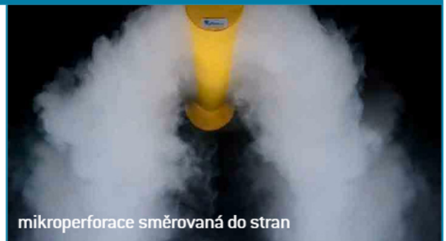
Příklady obrazů proudění vytvořených kouřovou zkouškou ve zkušebně PŘÍHODA s.r.o.
